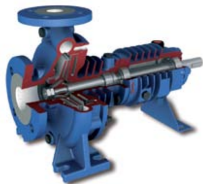
TCD – KONŠTRUKCIA PRE TEPOVÝMENNÉ OLEJE DO 320 °C S JEDNODUCHÝMI MECHANICKÝMI UPCHÁVKAMI BEZ NUTNOSTI CHLADENIA ODVODENÁ OD NORMY DIN 24258 CHEMICKÝCH ČERPADIEL; LOŽISKÁ SÚ MAZANÉ LOŽISKOVÝM OLEJOM A NIE ČERPANOU KVAPALINOU AKO PRI KONKURENČNÝCH VÝROBKACH
