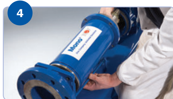
4 Rotor und Stator aus Pumpe entfernen
