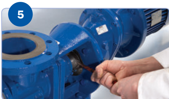
5 Wellenschutz zurückziehen und Mitnehmerstift aus Welle entfernen
