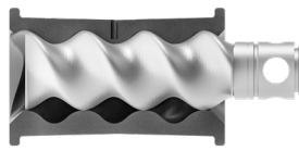
A geometria de passo 2:3 do estator/rotor encurta o comprimento total da bomba e gera níveis de pressão elevados mesmo a baixos binários.
