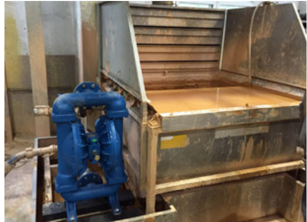
SANDPIPER S30 in Metallausführung bei Abfördern von schlammhaltigem Abwasser
