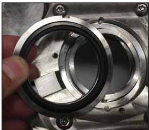
Bild 71 - Ta bort stationär tätning
