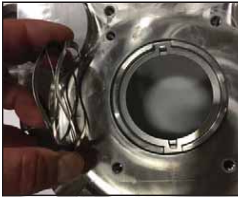
Bild 47 - Ta bort vågfjäder
