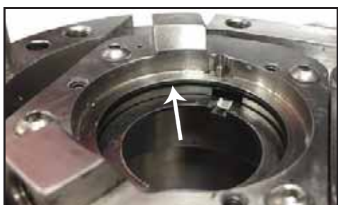
Bild 73 - Placering av tätning-O-ring
