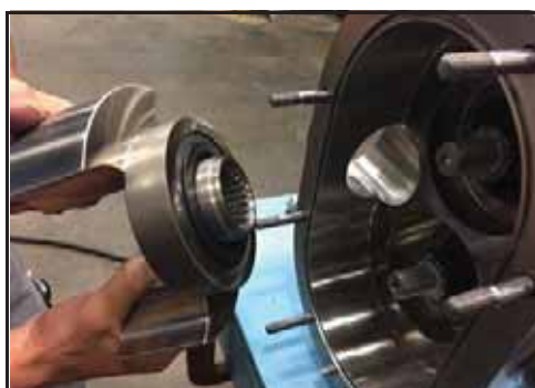
Bild 37 - Ta bort rotor
