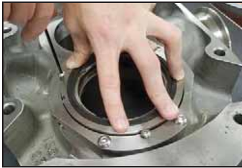
Bild 117 - Installera tätningens fästbultar
