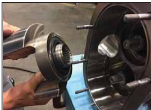
Bild 177 - Skjut på rotor på axel
