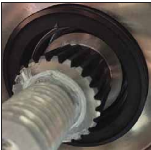
Bild 134 - Stationär tätning installerad
