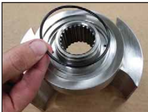
Bild 169 - Installera hylsans främre O-ring
