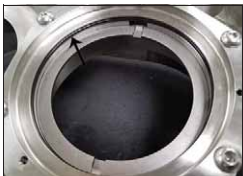
Bild 114 - Placering av tätning-O-ring
