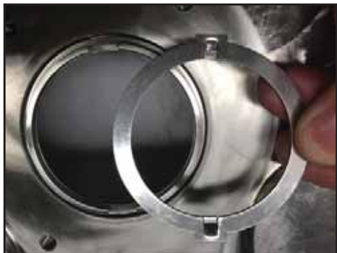
Bild 78 - Ta bort drivring
