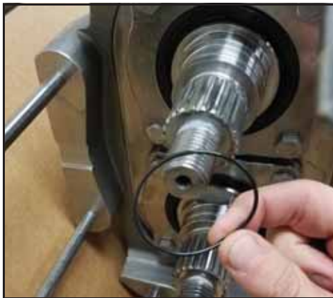
Bild 154 - Ta bort O-ring
