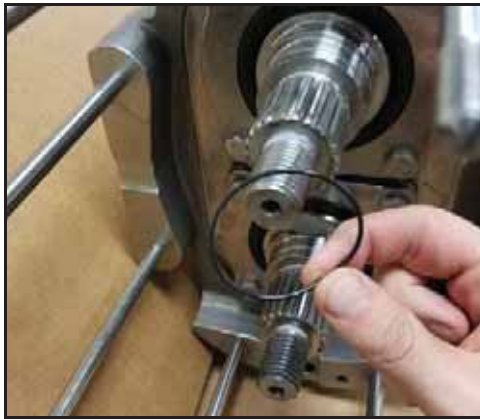
Bild 160 - Smörj och installera O-ring
