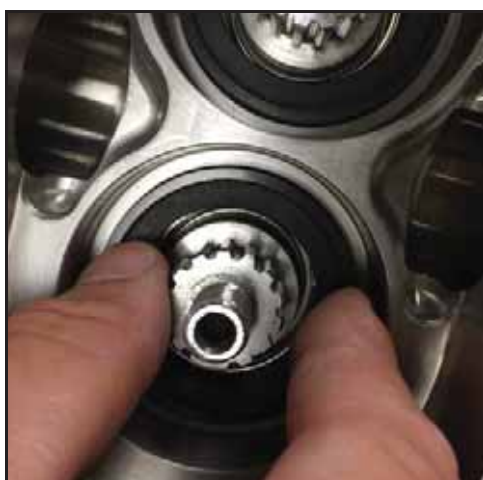
Bild 133 - Tryck på stationär tätning
