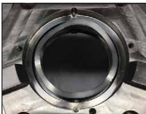
Bild 93 - Våg fjäder installerad
