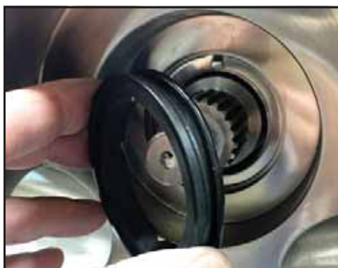
Bild 40 - Ta bort stationär tätning
