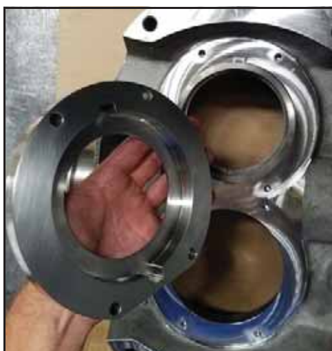
Bild 46 - Ta bort tätningshus
