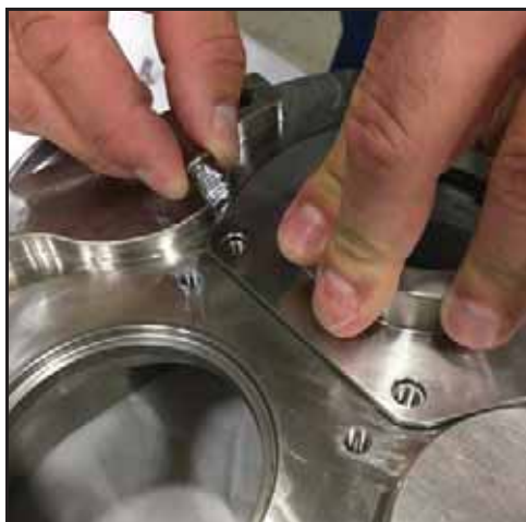
Bild 44 - Ta bort tätningshusbultar
