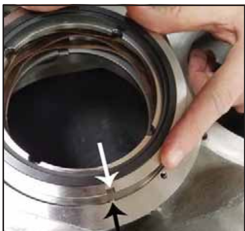
Bild 116 - Installera spolsidans stationära tätning
