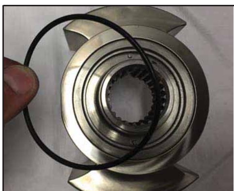
Bild 39 - Ta bort tätnings-O-ring
