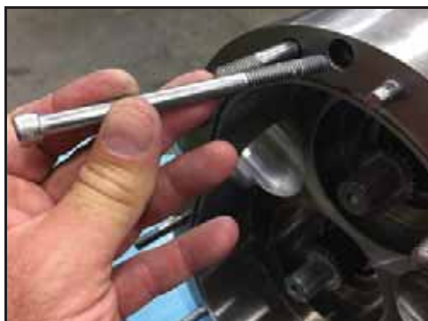
Bild 167 - Installera pumphusets fästsruvar
