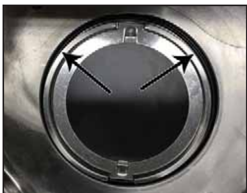
Bild 86 - Tätningshusets O-ring installerad
