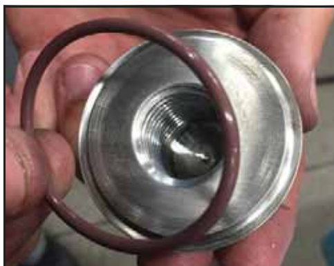
Bild 36 - Ta bort O-ring
