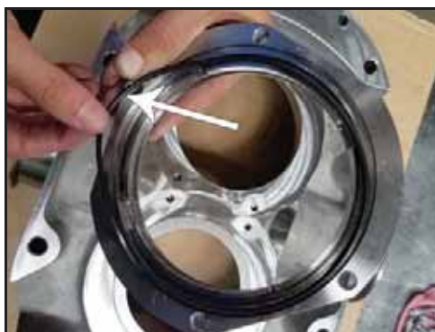
Bild 77 - Ta bort tätningshusets O-ring
