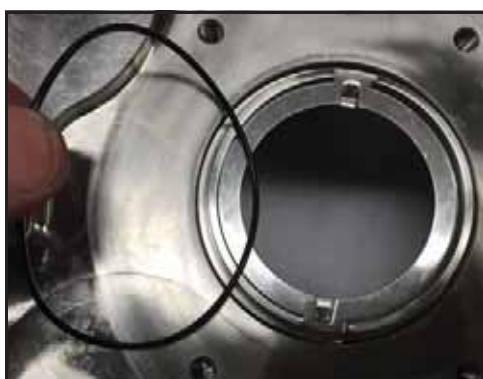
Bild 76 - Ta bort tätningshusets O-ring
