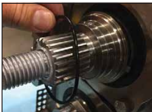
Bild 67 - Ta bort O-ring
