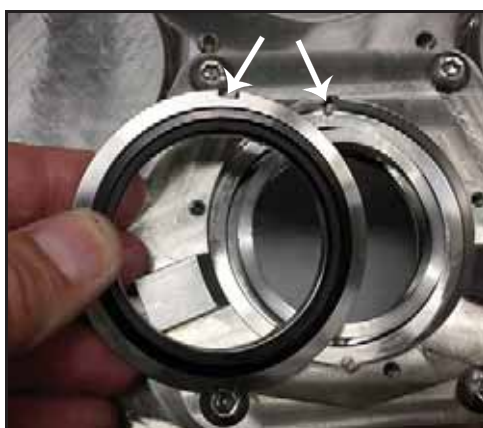
Bild 94 - Installera spolsidans stationära tätning
