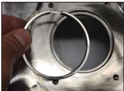
Bild 79 - Ta bort axelring
