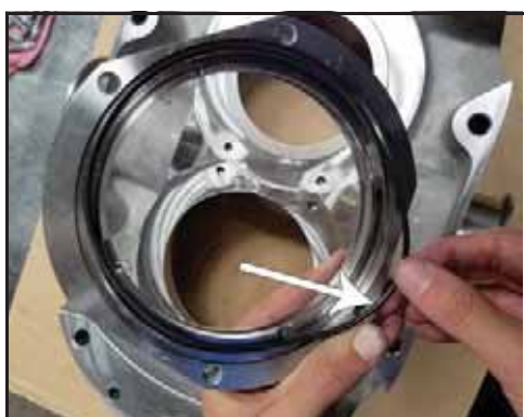
Bild 109 - Installera tätningshusets O-ring
