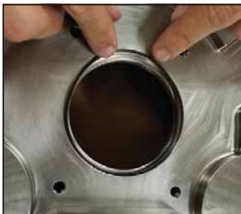
Bild 151 - Ta bort O-ring
