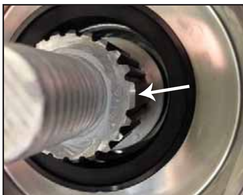
Bild 176 - Timingsspline på axel
