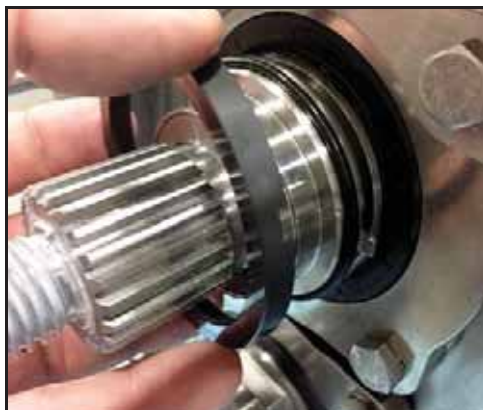
Bild 66 - Ta bort spolsidans roterande tätning
