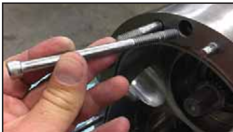
Bild 42 - Ta bort skruvarna som håller pumphuset på plats
