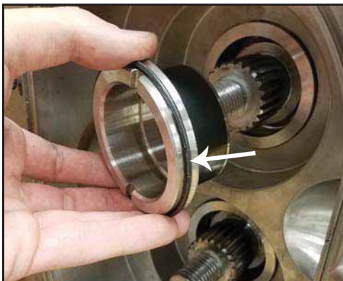
Bild 142 - Ta bort hylsan, O-ring
