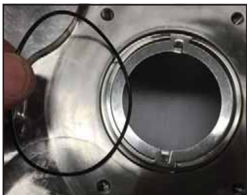
Bild 85 - Installera tätningshusets O-ring
