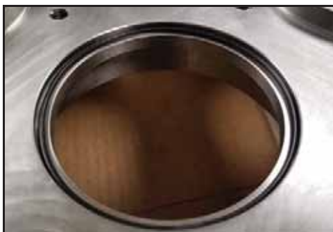
Bild 155 - Tätningshusets O-ring installerad
