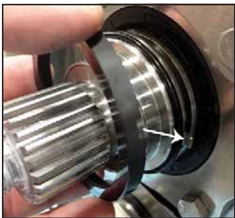
Bild 105 - Installera spolsidans roterande tätning
