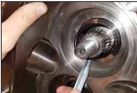
Bild 143 - Ta bort O-ring
