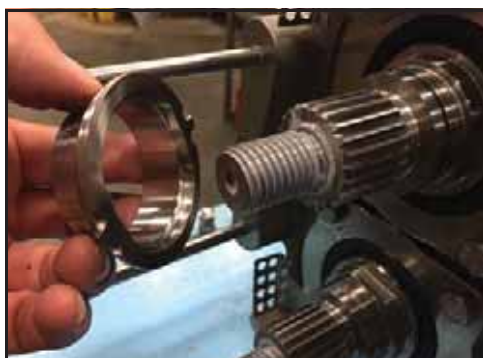
Bild 101 - Installera justerad ring
