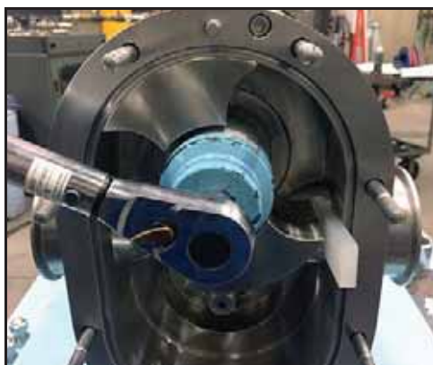
Bild 35 - Ta bort rotormutter
