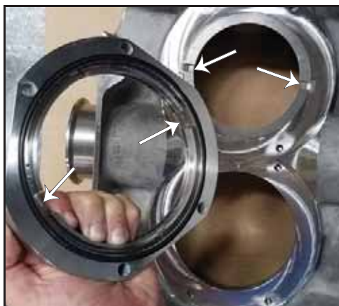
Bild 110 - Tätningshusets O-ring installerad
