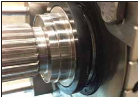
Bild 126 - Roterande tätning installerad
