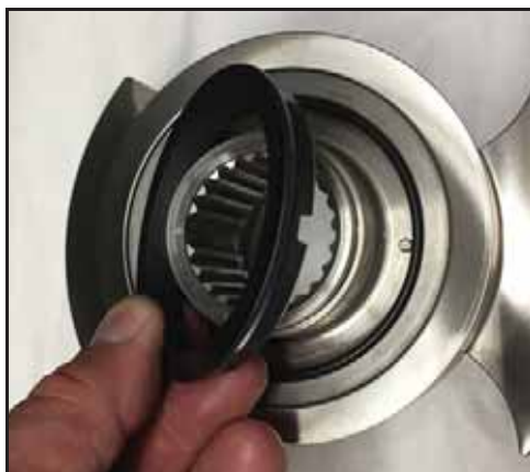
Bild 38 - Ta bort roterande tätning
