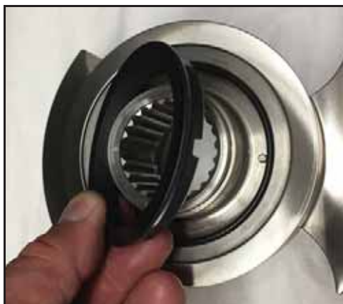
Bild 137 - Installera roterande tätning
