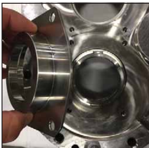
Bild 45 - Ta bort tätningshus
