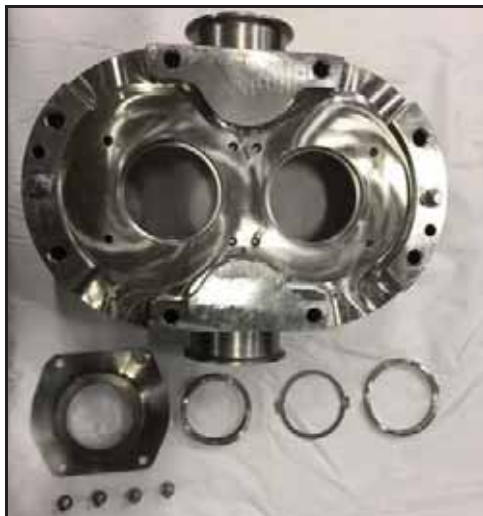
Bild 50 - Enkel mekanisk tätning (040-U3 visad)
