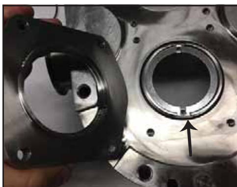
Bild 75 - Ta bort tätningshus
