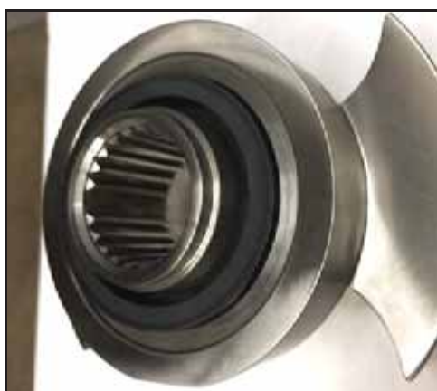
Bild 138 - Roterande tätning installerad
