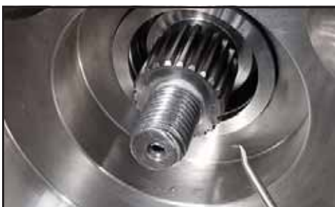
Bild 144 - Ta bort O-ring
