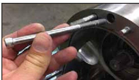
Bild 147 - Ta bort skruvarna som håller pumphuset på plats
