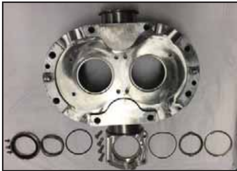
Bild 80 - Dubbel mekanisk tätning (040-U3 visad)
