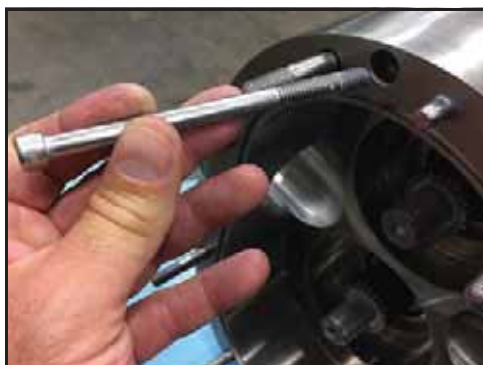
Bild 129 - Installera pumphusets fästskruvar
