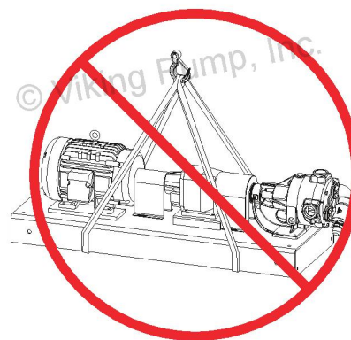
FIGURE A8 : EXEMPLE DE METHODE DE LEVAGE INCORRECTE
