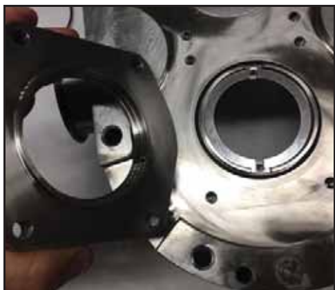
Obrázek 87 - Montáž pouzdra ucpávky
