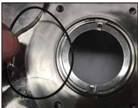
Obrázek 76 - Demontáž O-kroužku pouzdra ucpávky
