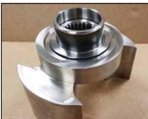
Obrázek 173 - Namontovaná objímka ucpávky
