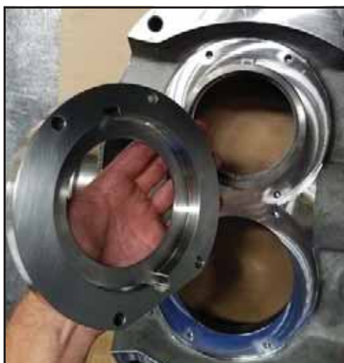
Obrázek 46 - Demontáž pouzdra ucpávky
