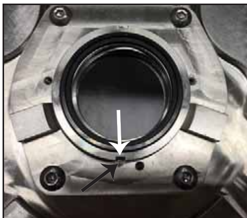
Obrázek 95 - Namontovaná stacionární ucpávka na straně oplachu
