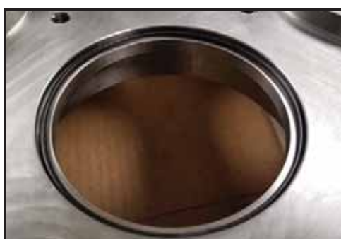
Obrázek 155 - Namontovaný O-kroužek pouzdra ucpávky
