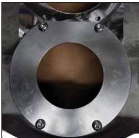
Obrázek 65 - Namontované pouzdro ucpávky
