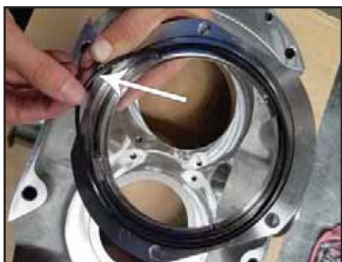
Obrázek 77 - Demontáž O-kroužku pouzdra ucpávky
