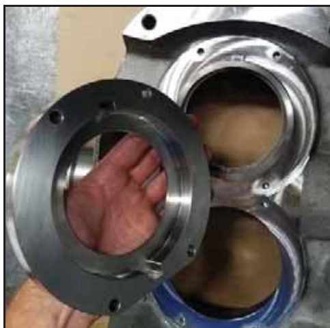
Obrázek 63 - Montáž pouzdra ucpávky
