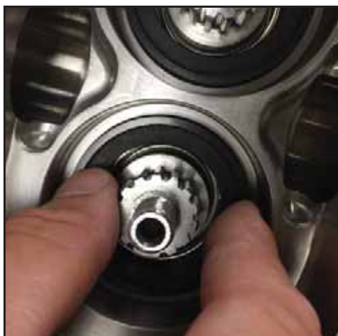
Obrázek 133 - Zatlačená stacionární ucpávka
