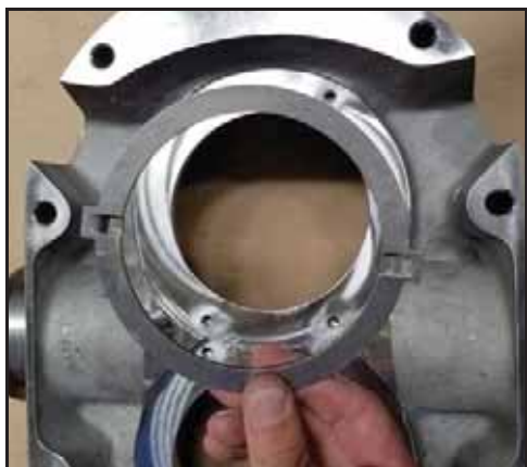
Obrázek 107 - Montáž kroužku pohonu
