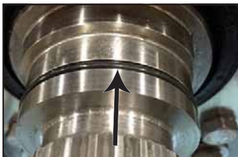
Obrázek 69 - O-kroužek stavěcího kroužku
