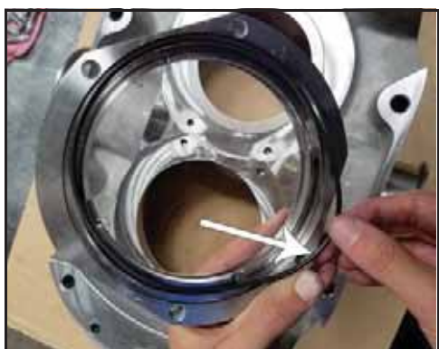
Obrázek 109 - Montáž O-kroužku pouzdra ucpávky
