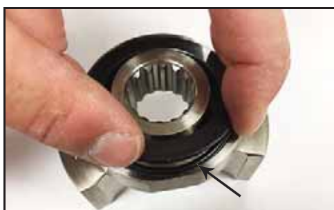
Obrázek 139 - Skřípnutý O-kroužek těsnění
