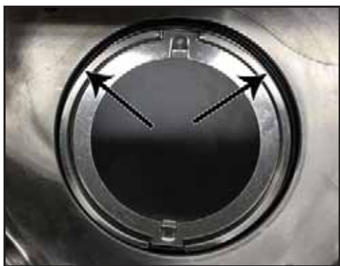
Obrázek 86 - Namontovaný O-kroužek pouzdra ucpávky
