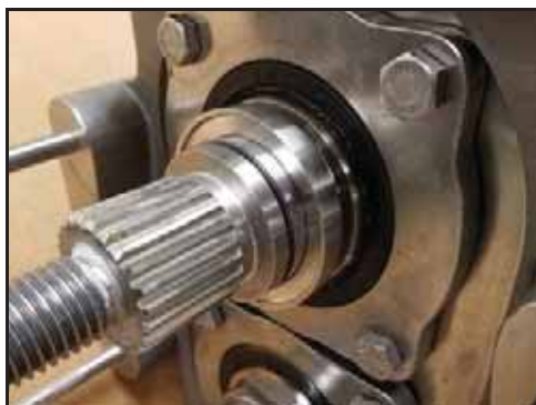
Obrázek 163 - Namontované sedlo ucpávky
