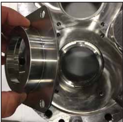
Obrázek 57 - Montáž pouzdra ucpávky
