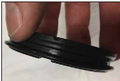
Obrázek 131 - Namontovaný O-kroužek těsnění
