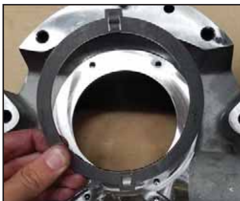
Obrázek 60 - Montáž kroužku pohonu
