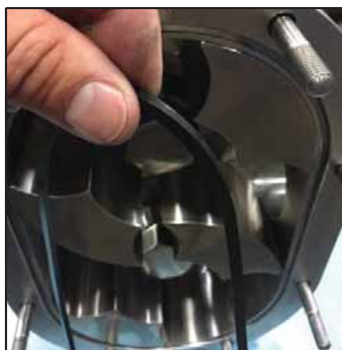
Obrázek 34 - Demontáž plochého těsnění krytu
