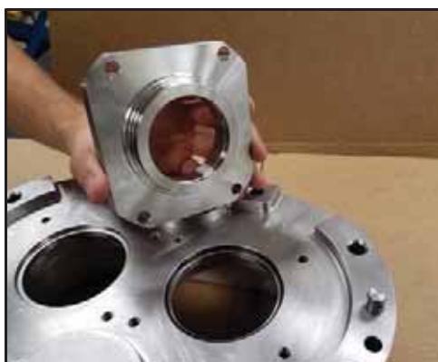
Obrázek 150 - Demontáž pouzdra ucpávky
