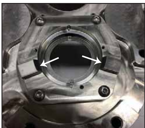
Obrázek 89 - Namontované pouzdro ucpávky
