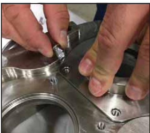
Obrázek 58 - Montáž šroubů pouzdra ucpávky
