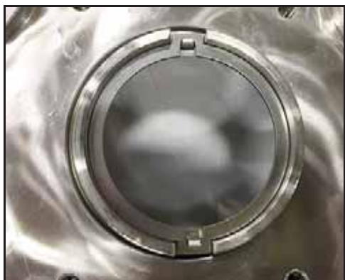
Obrázek 84 - Namontovaný kroužek pohonu
