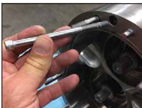
Obrázek 129 - Montáž šroubů upevňujících těleso
