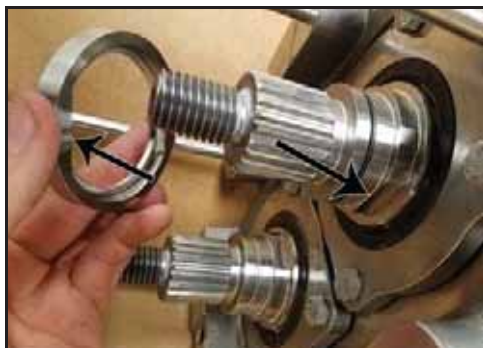
Obrázek 162 - Montáž sedla ucpávky
