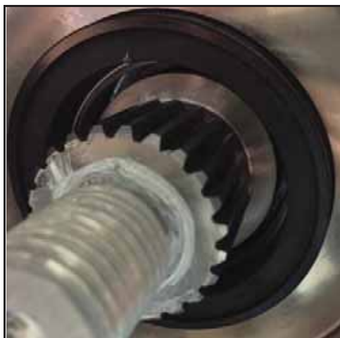
Obrázek 134 - Namontovaná stacionární ucpávka
