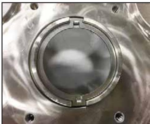
Obrázek 54 - namontovaný kroužek pohonu (130-U3 a menší)
