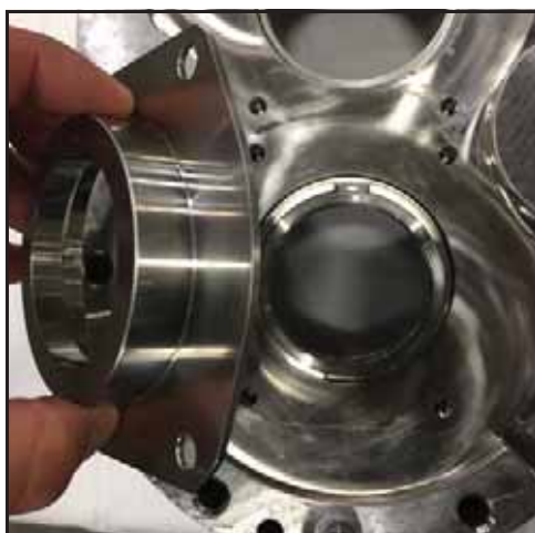
Obrázek 45 - Demontáž pouzdra ucpávky
