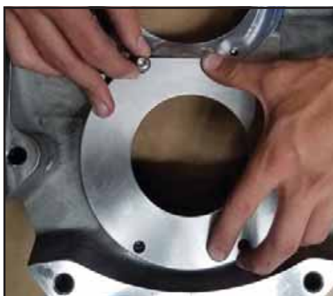
Obrázek 64 - Montáž šroubů pouzdra ucpávky
