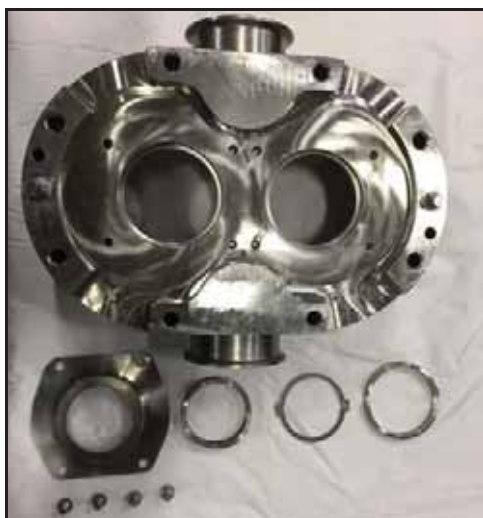
Obrázek 50 - Jednoduchá mechanická ucpávka (na obrázku je 040-U3)
