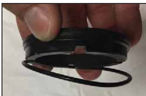
Obrázek 41 - O-kroužek stacionární ucpávky
