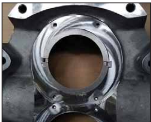
Obrázek 108 - Namontovaný kroužek pohonu
