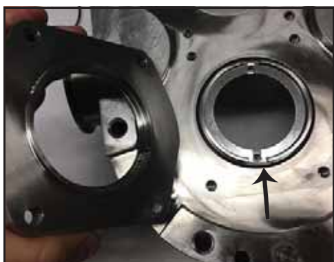
Obrázek 75 - Demontáž pouzdra ucpávky
