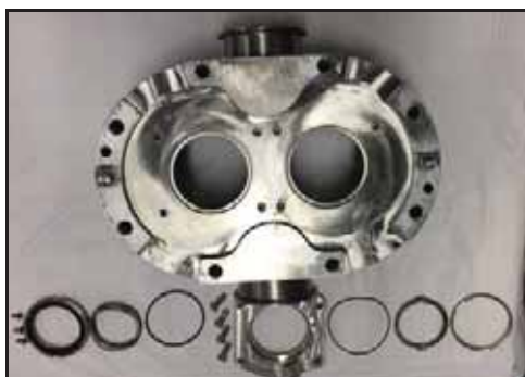
Obrázek 80 - Dvojitá mechanická ucpávka (na obrázku je 040-U3)
