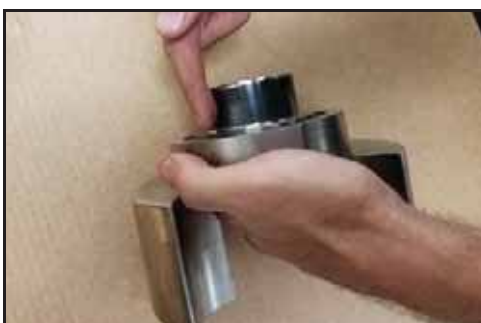
Obrázek 174 - Mazání objímky ucpávky
