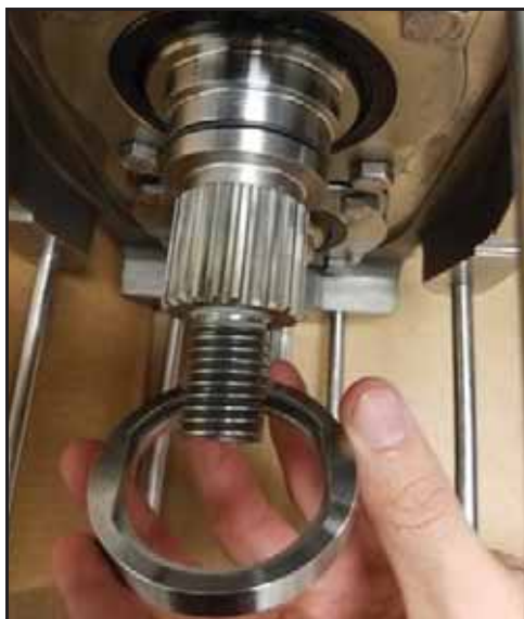
Obrázek 153 - Demontáž sedla ucpávky
