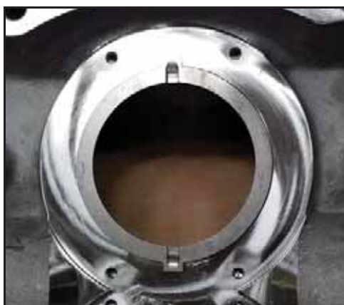
Obrázek 61 - Namontovaný kroužek pohonu
