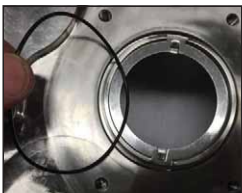
Obrázek 85 - Montáž O-kroužku pouzdra ucpávky
