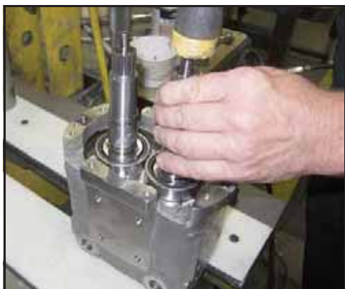
Obrázek 191 - Klepnutím hřídele v otvorech vycentrujte
