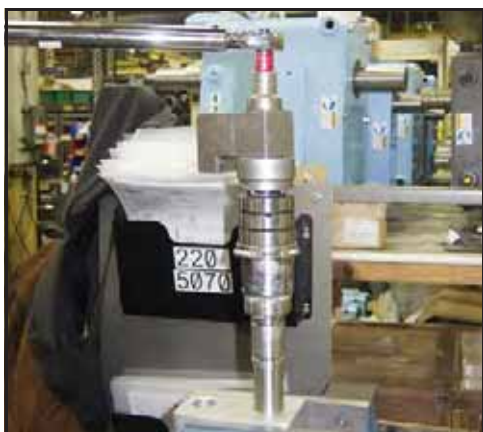
Obrázek 179 - Dotáhněte pojistnou matici na předepsaný moment
