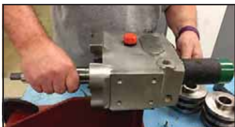
Obrázek 147 - Klepnutím vyjměte krátkou hřídel z převodové skříně
