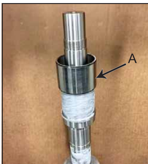
Obrázek 154 - Nasad'te vnitřní oběžnou drážku na hřídel
