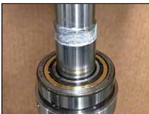
Obrázek 167 - Oběžná drážka nainstalovaná na hřídeli
