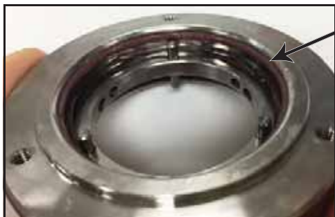
Obrázek 72 - Nainstalovaný O-kroužek mezi unašečem a ucpávkou
