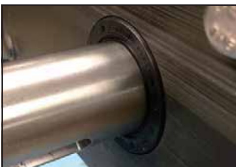
Obrázek 239 - Nainstalované olejové těsnění
