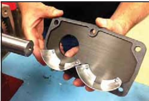
Obrázek 234 - Umístěte na kryt ploché těsnění
