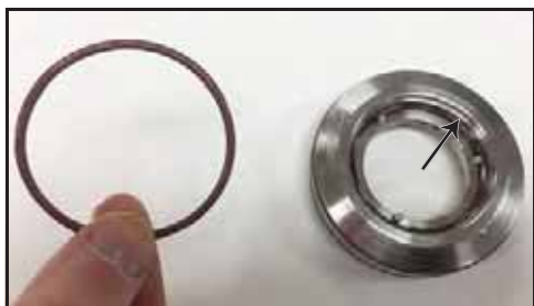
Obrázek 69 - O-kroužek mezi unašečem a ucpávkou
