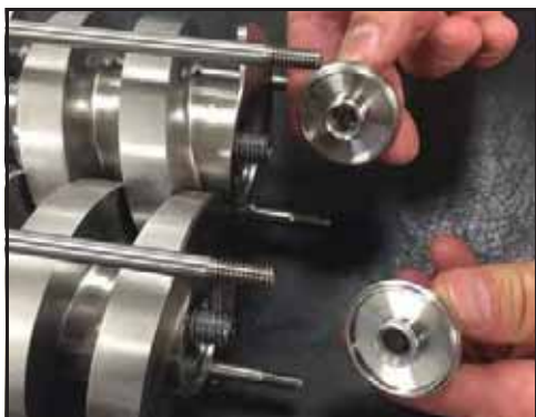
Obrázek 217 - Nainstalujte matice rotorů
