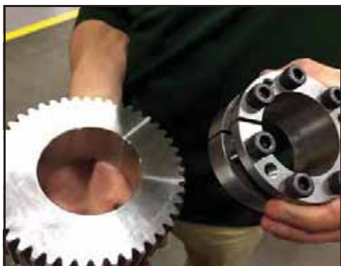
Obrázek 211 - Namontujte pojistnou sestavu na kolo
