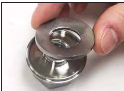
Obrázek 113 - Nainstalujte talířovou pružinovou podložku
