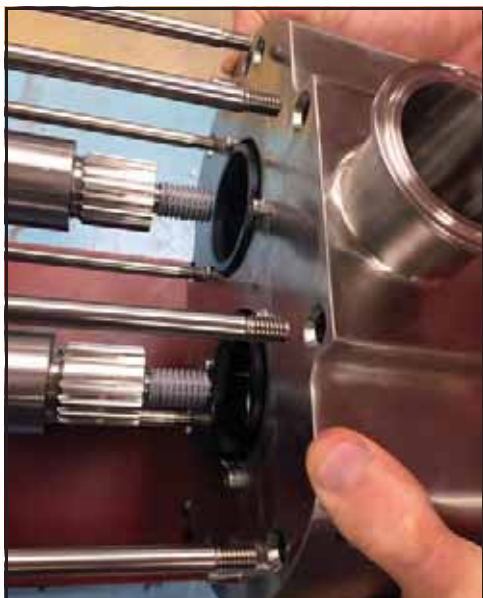
Obrázek 87 - Nainstalujte těleso čerpadla na hřídele
