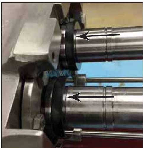
Obrázek 86 - Nainstalovaná sedla ucpávky
