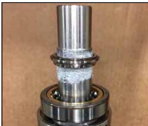
Obrázek 166 - Nasad'te oběžnou drážku na hřídel
