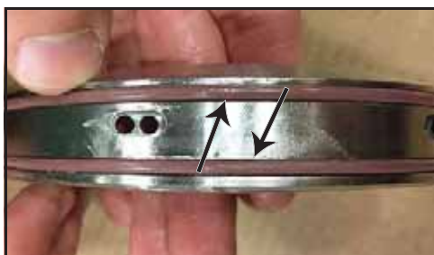
Obrázek 62 - O-kroužky mezi unašečem a tělesem
