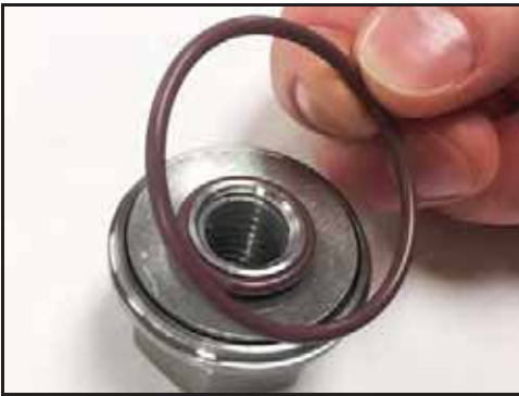
Obrázek 38 - Vyjměte O-kroužek matice rotoru
