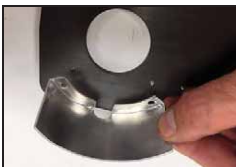
Obrázek 230 - Vyrovnajte otvory pro šrouby
