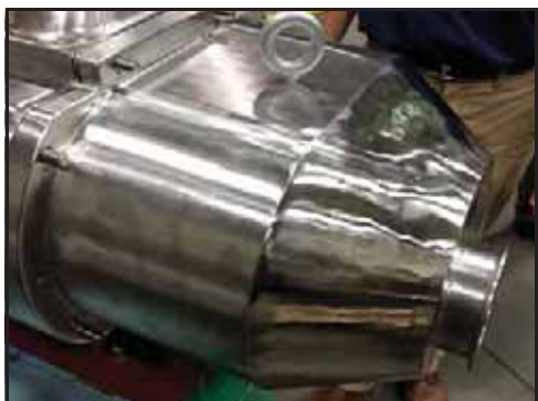
Obrázek 130 - Doražte kryt čerpadla na těleso čerpadla
