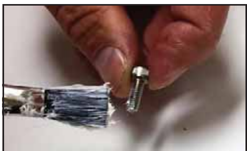
Obrázek 79 - Použijte prostředek proti „srůstání“ závitů
