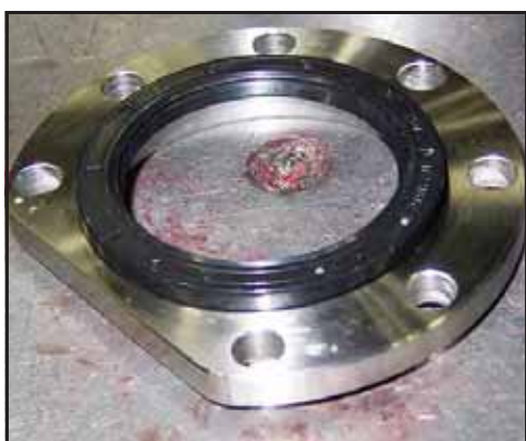
Obrázek 193 - Vycentrujte těsnění na přídržné desce ložiska
