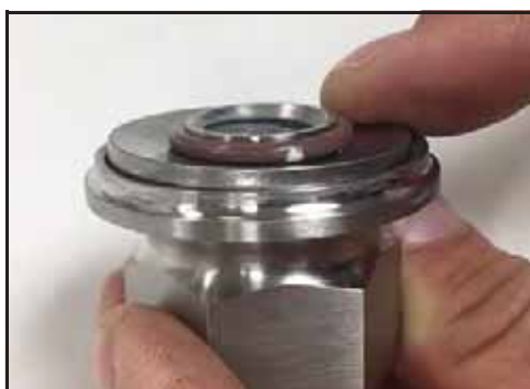
Obrázek 115 - Nainstalovaná talířová pružinová podložka
