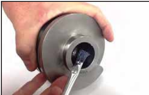
Obrázek 106 - Použijte prostředek proti „srůstání“ závitů
