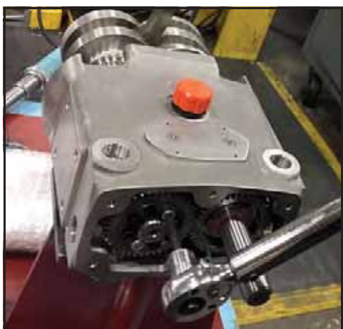
Obrázek 227 - Dotáhněte šrouby pojistné sestavy na předepsaný moment
