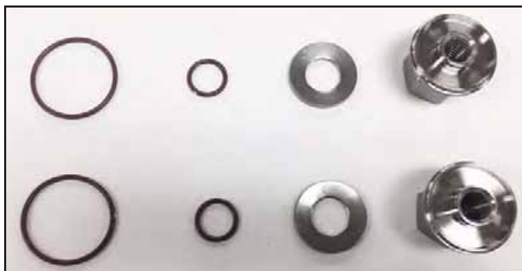
Obrázek 112 - Součásti matice rotoru
