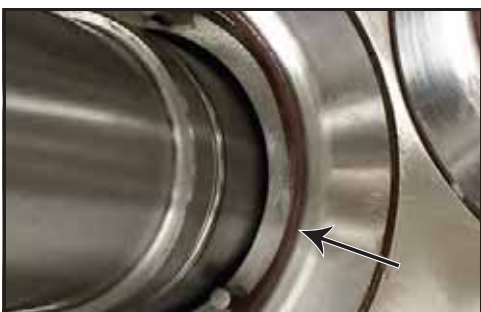
Obrázek 93 - Nainstalujte O-kroužek mezi unašečem a ucpávkou
