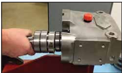
Obrázek 148 - Vytáhněte krátkou hřídel z převodové skříně
