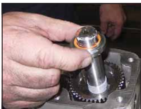
Obrázek 204 - Nainstalujte pojistnou matici
