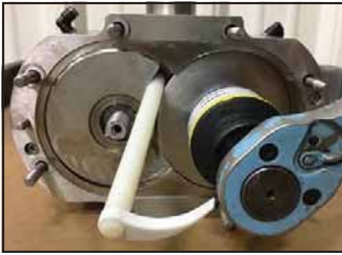
Obrázek 34 - Vložte čepovitou část
