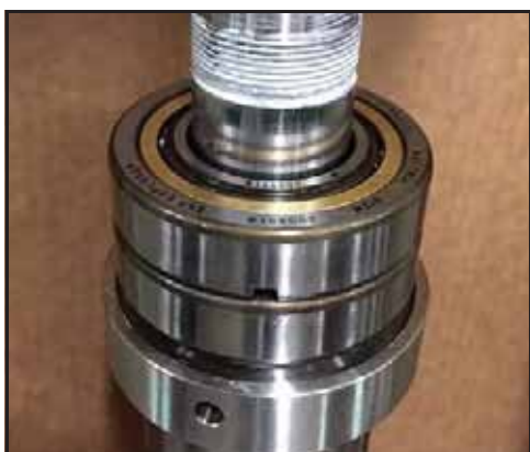
Obrázek 173 - Druhé nainstalované ložisko
