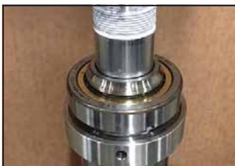
Obrázek 169 - Natlačte oběžnou drážku do ložiska
