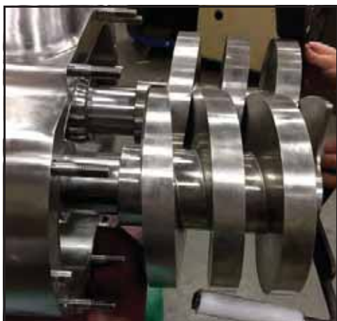
Obrázek 110 - Nasaňte rotory na hřídele
