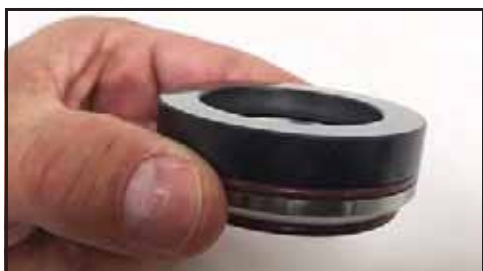
Obrázek 102 - Sedlo ucpávky nainstalované na víko ucpávky
