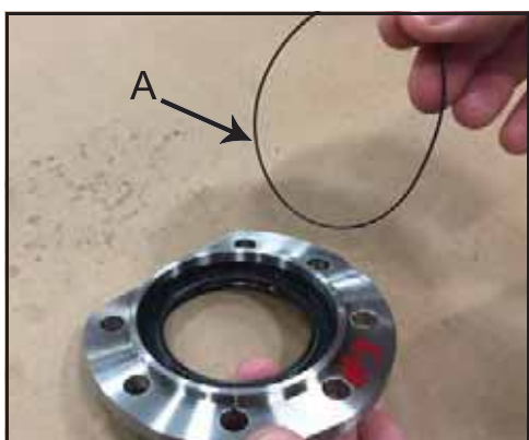
Obrázek 196 - Nainstalujte O-kroužek přídržné desky ložiska
