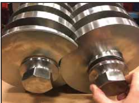
Obrázek 37 - Sejměte matice rotorů
