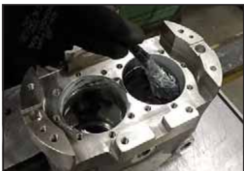
Obrázek 184 - Použijte prostředek proti „srůstání“ závitů
