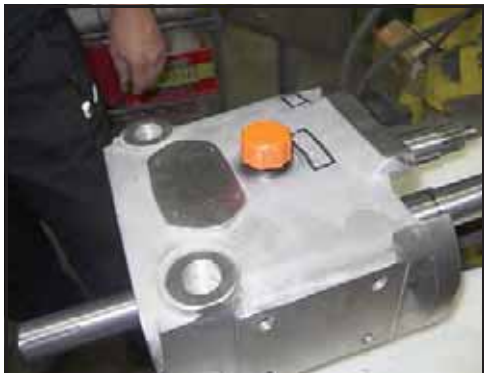
Obrázek 208 - Nainstalujte odvzdušňovací zátku
