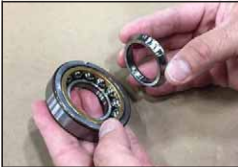
Obrázek 160 - Vyjměte spodní oběžnou drážku
