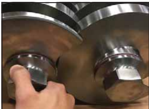
Obrázek 124 - Nainstalujte matice rotorů
