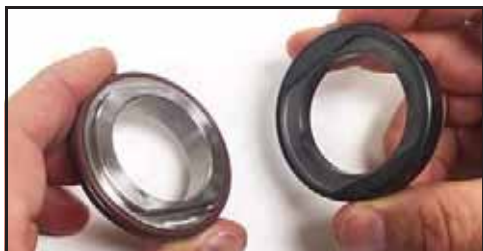
Obrázek 101 - Vyrovnějte víko ucpávky a sedlo ucpávky
