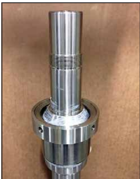
Obrázek 158 - Nainstalovaná podložka ložiska
