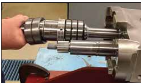
Obrázek 146 - Vytáhněte hnací hřídel z převodové skříně
