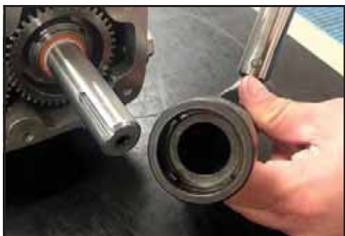
Obrázek 140 - Nástroj pro dotahování matice převodu
