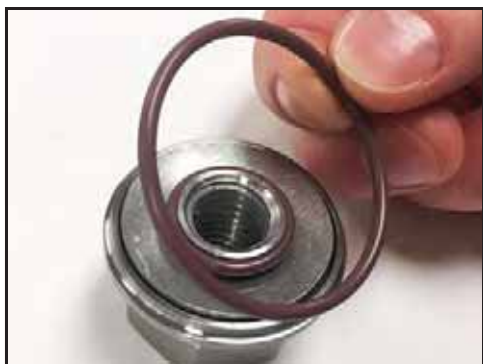
Obrázek 116 - Nainstalujte O-kroužek matice rotoru
