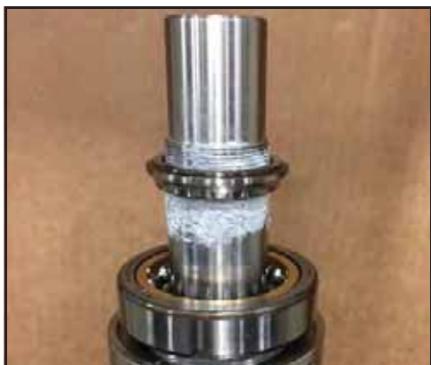
Obrázek 171 - Nasad'te oběžnou drážku na hřídel
