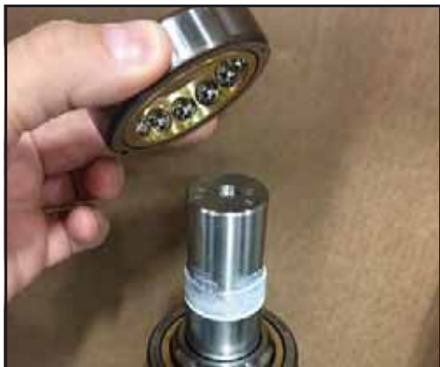
Obrázek 170 - Umístěte ložisko na oběžnou drážku
