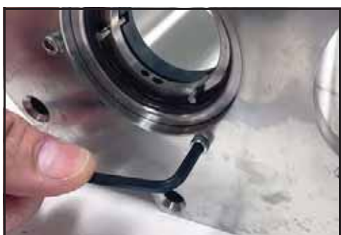
Obrázek 80 - Zašroubujte šrouby víka
