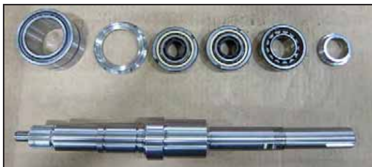
Obrázek 150 - Hnací hřídel: Položky potřebné pro montáž
