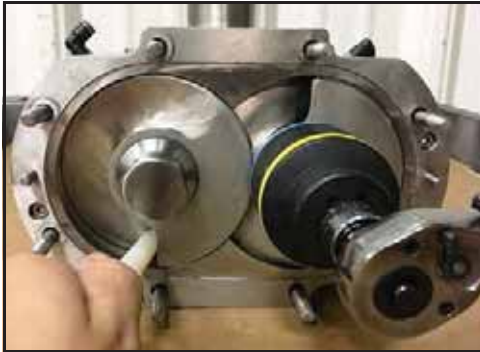
Obrázek 121 - Vložte klínový nástroj
