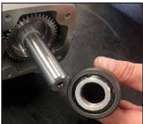
Obrázek 142 - Demontujte pojistnou matici a převod
