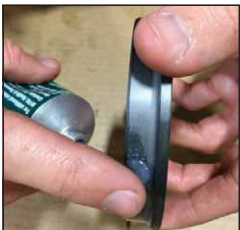
Obrázek 81 - Namažte vnější průměr ucpávky
