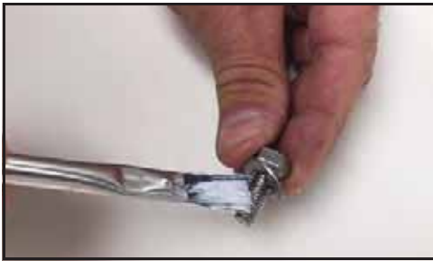
Obrázek 236 - Použijte prostředek proti „srůstání“ závitů
