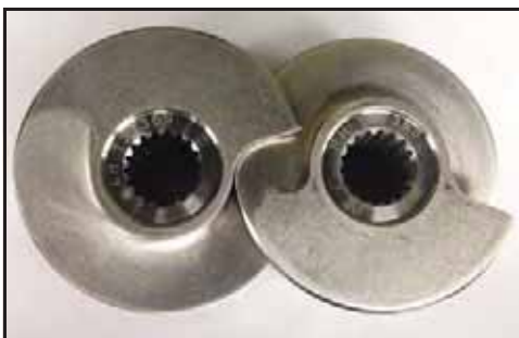
Obrázek 107 - Uspořádání rotorů: levý-pravý
