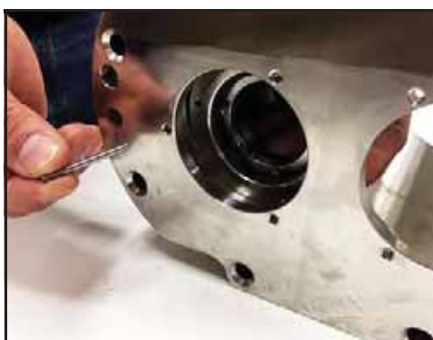
Obrázek 77 - Pro vyrovnání otvorů použijte čep
