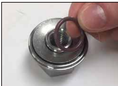
Obrázek 114 - Nainstalujte O-kroužek přidržující podložku
