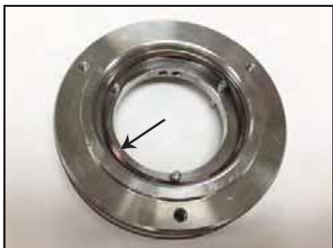
Obrázek 71 - Nainstalovaná vlnová pružina ucpávky
