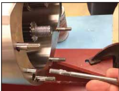
Obrázek 51 - Demontujte šrouby upevňující těleso
