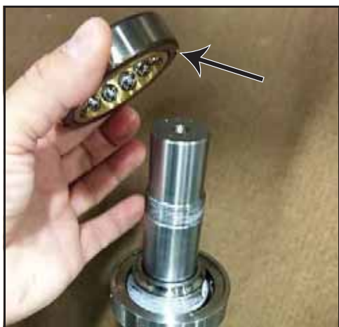
Obrázek 165 - Umístěte ložisko na oběžnou drážku
