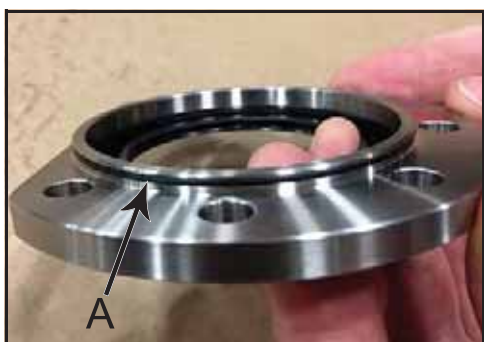
Obrázek 197 - Nainstalovaný O-kroužek přídržné desky ložiska
