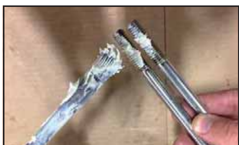
Obrázek 89 - Naneste na závity prostředek proti „srůstání“ závitu
