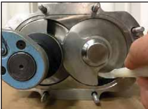
Obrázek 32 - Vložte klínový nástroj
