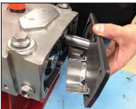
Obrázek 235 - Nainstalujte kryt převodové skříně
