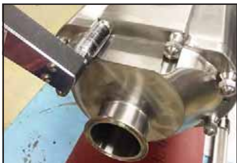
Obrázek 27 - Vyšroubujte matice z krytu
