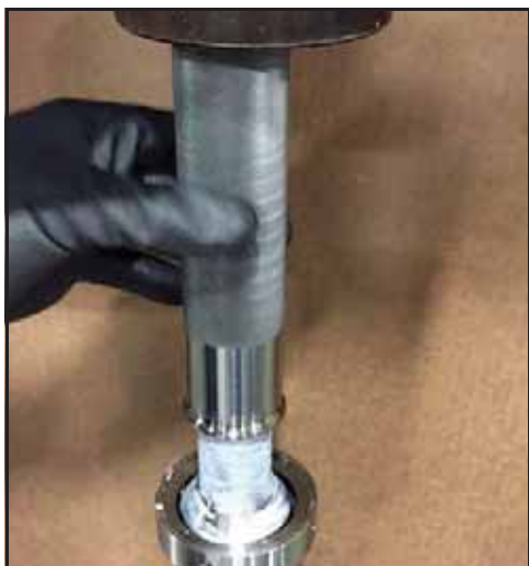
Obrázek 163 - Natlačte oběžnou drážku na hřídel
