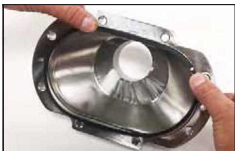
Obrázek 29 - Odstraňte ploché těsnění krytu
