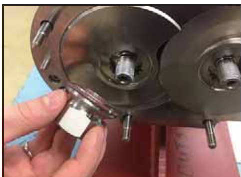
Obrázek 119 - Nainstalujte matice rotorů
