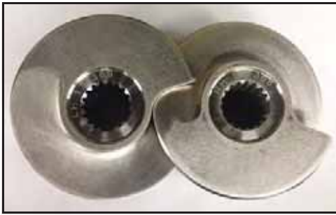
Obrázek 42 - Uspořádání rotorů: levý – pravý
