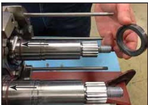
Obrázek 54 - Demontujte O-kroužky hřídele
