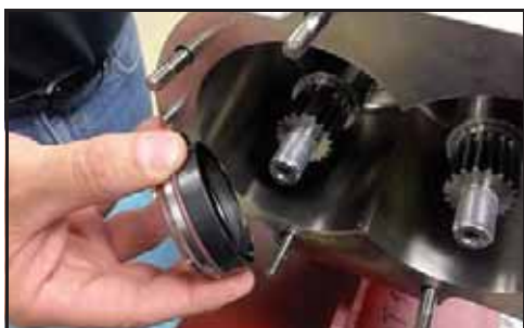
Obrázek 103 - Nainstalujte sestavu víka ucpávky
