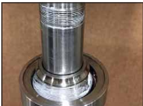
Obrázek 164 - Oběžná drážka natlačená na hřídeli
