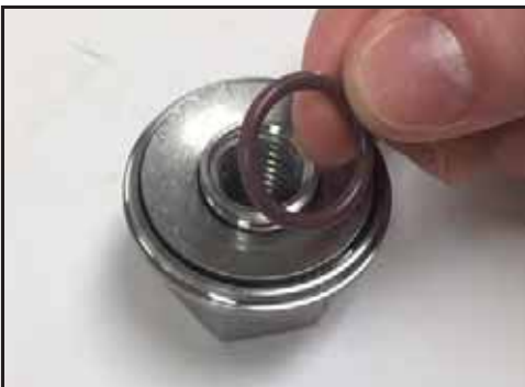
Obrázek 39 - Vyjměte O-kroužek přidržující podložku
