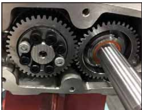
Obrázek 214 - Vyrovnajte volné kolo s hnacím kolem
