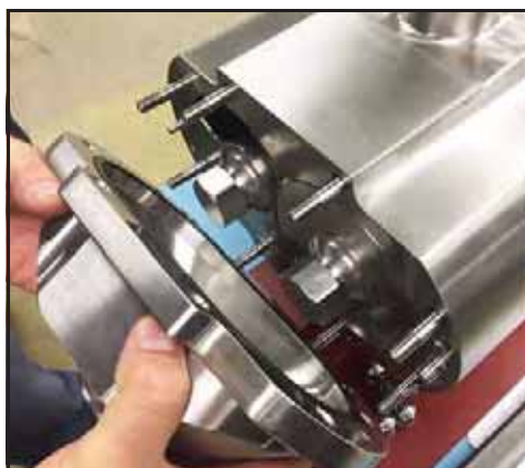
Obrázek 128 - Nainstalujte kryt čerpadla
