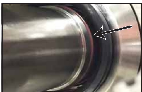
Obrázek 91 - Nainstalujte O-kroužek hřídele
