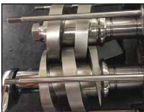
Obrázek 220 - Nainstalujte matice rotorů
