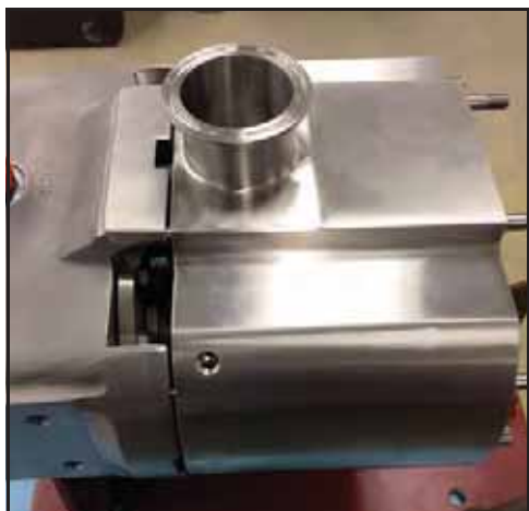
Obrázek 88 - Nainstalované těleso čerpadla
