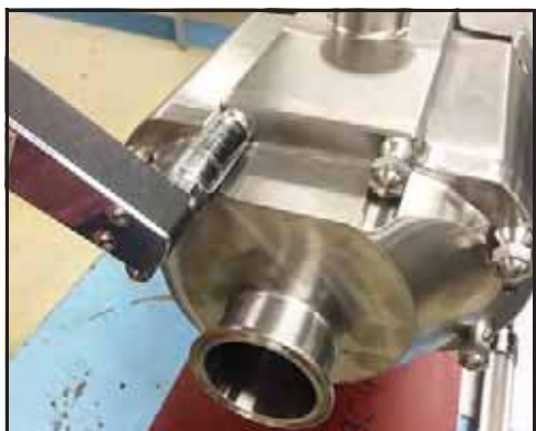
Obrázek 132 - Dotáhněte matice krytu
