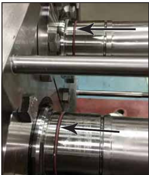
Obrázek 84 - Nainstalujte O-kroužky hřídelí
