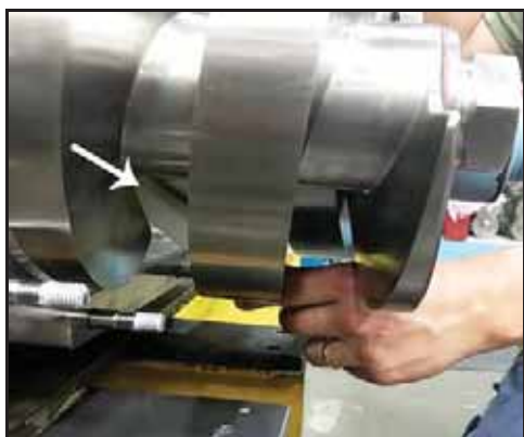
Obrázek 126 - Zablokujte pravý rotor
