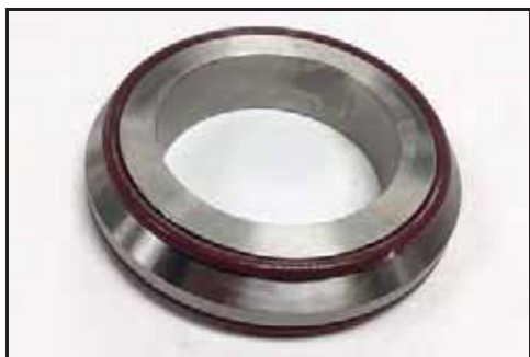
Obrázek 100 - Nainstalovaný O-kroužek mezi víkem a rotorem
