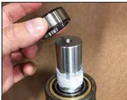
Obrázek 175 - Nasad'te oběžnou drážku na hřídel
