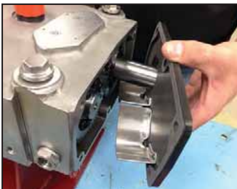
Obrázek 135 - Sejměte kryt převodové skříně
