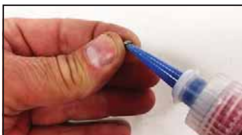
Obrázek 231 - Naneste přípravek Loctite®
