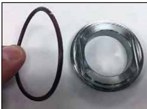
Obrázek 46 - Vyjměte O-kroužek mezi víkem a sedlem
