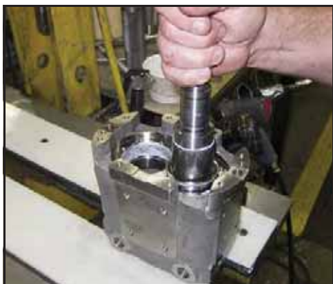
Obrázek 186 - Vložte do otvoru krátkou hřídel
