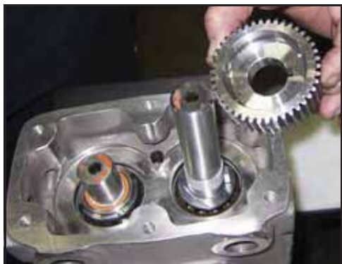
Obrázek 202 - Nainstalujte hnací kolo
