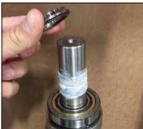
Obrázek 168 - Nasad'te oběžnou drážku na hřídel
