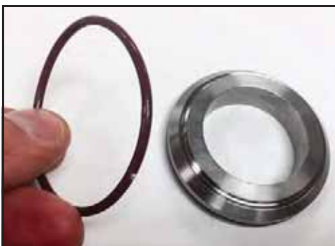
Obrázek 45 - Vyjměte O-kroužek mezi víkem a rotorem
