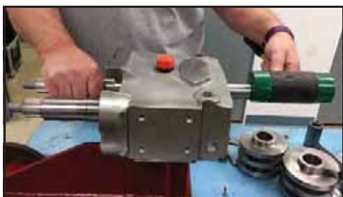
Obrázek 145 - Klepnutím vyjměte hnací hřídel z převodové skříně
