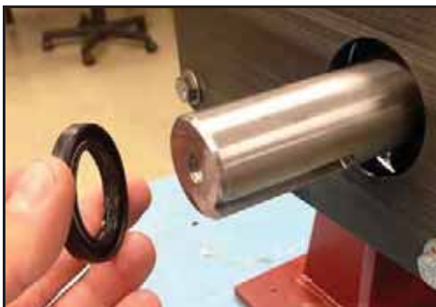
Obrázek 238 - Nainstalujte olejové těsnění
