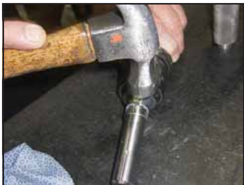
Obrázek 182 - Vsaďte klepnutím klín do klínové drážky
