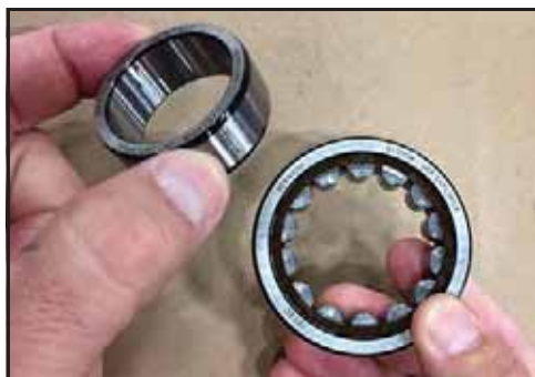
Obrázek 174 - Vyjměte oběžnou drážku z ložiska
