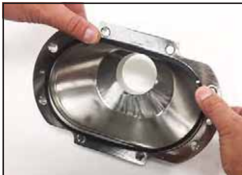
Obrázek 127 - Nainstalujte ploché těsnění krytu
