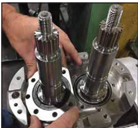
Obrázek 199 - Nainstalujte přídržnou desku ložiska
