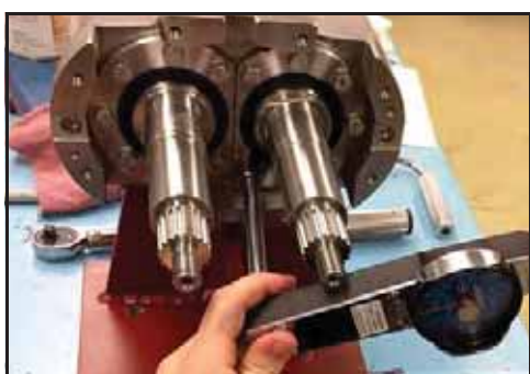
Obrázek 201 - Dotáhněte šrouby přídržné desky ložiska na předepsaný moment
