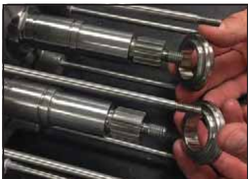
Obrázek 215 - Nainstalujte víka ucpávky
