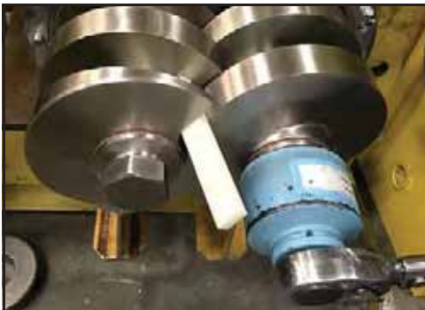
Obrázek 36 - Vložte nástroj pro blokování
