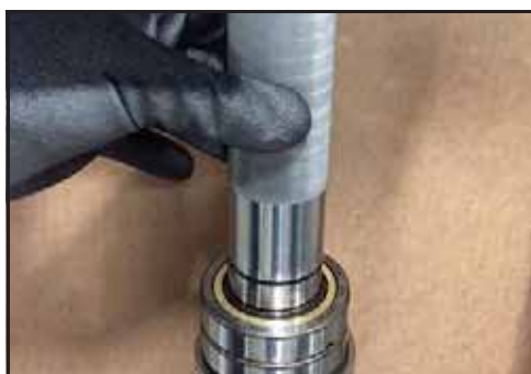
Obrázek 176 - Natlačte oběžnou drážku na hřídel
