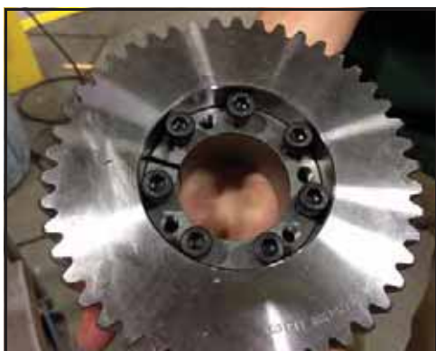
Obrázek 212 - Nasad'te pojistnou sestavu na kolo
