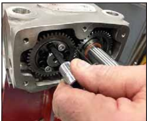
Obrázek 226 - Ručně dotáhněte šrouby pojistné sestavy
