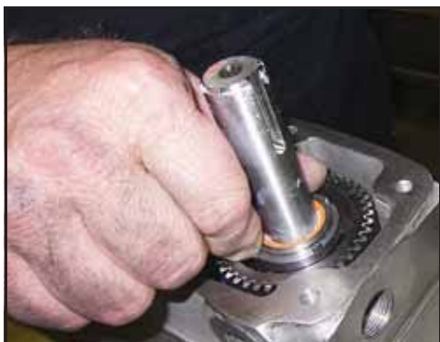
Obrázek 205 - Nainstalujte pojistnou matici
