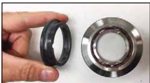
Obrázek 73 - Namažte a nainstalujte ucpávku
