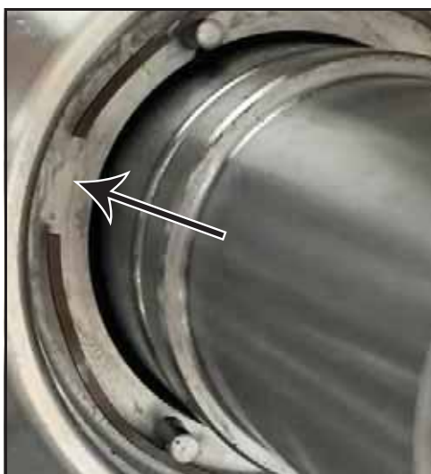
Obrázek 68 - Pozice vlnové pružiny ucpávky
