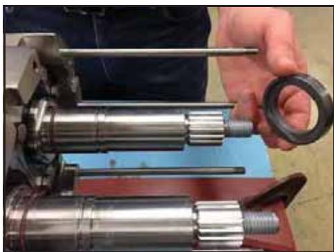
Obrázek 85 - Nainstalujte sedla ucpávky
