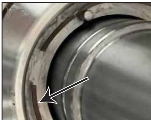
Obrázek 50 - Demontujte vlnitou pružinu ucpávky
