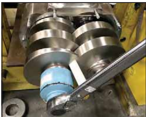
Obrázek 125 - Dotáhněte matici levého rotoru na požadovaný moment
