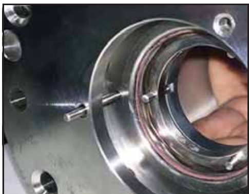
Obrázek 78 - Pro vyrovnání otvorů použijte čep
