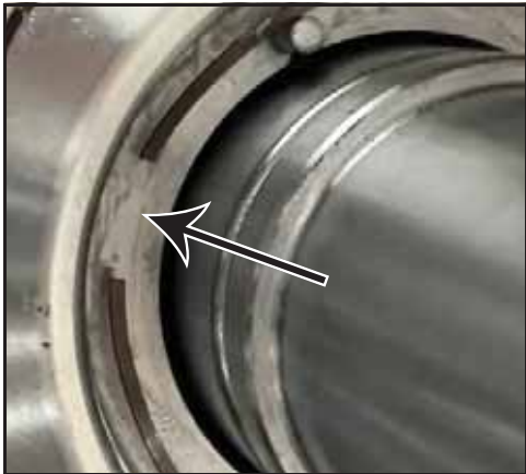
Obrázek 92 - Pozice vlnové pružiny ucpávky
