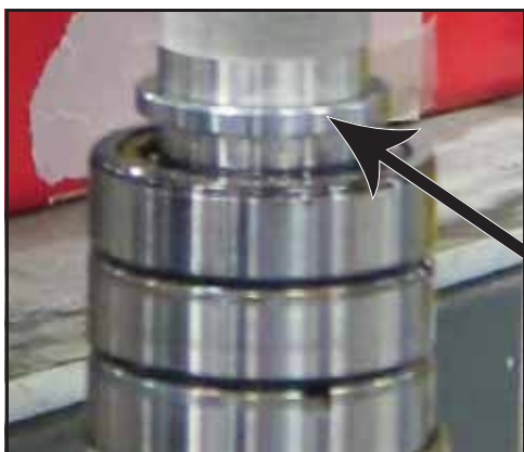
Obrázek 180 - Natlačte podložku převodu na hnací hřídel
