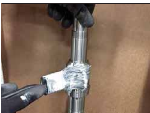
Obrázek 152 - Použijte prostředek proti „srůstání“ závitů
