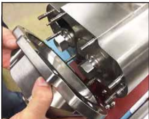
Obrázek 28 - Demontujte kryt čerpadla
