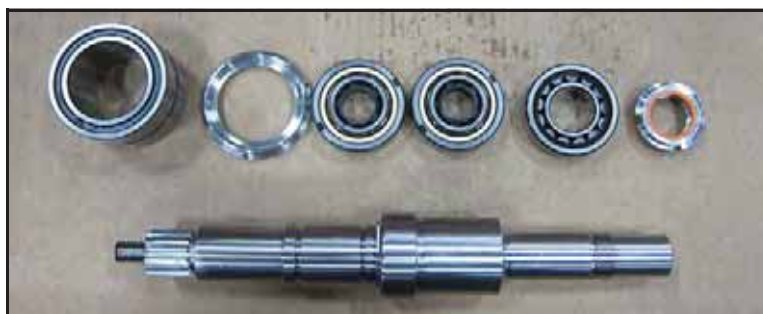
Obrázek 151 - Krátká hřídel: Položky potřebné pro montáž
