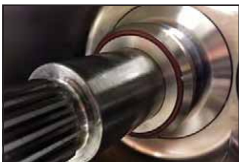
Obrázek 104 - Víko ucpávky nasazené na hřídeli
