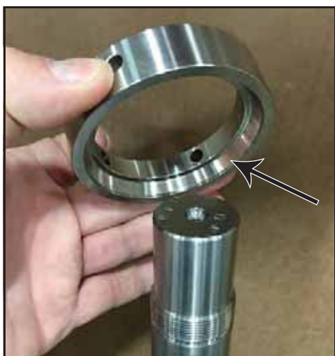
Obrázek 157 - Nasad'te podložku ložiska na hřídel
