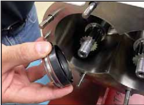
Obrázek 43 - Odstraňte sestavu víka ucpávky
