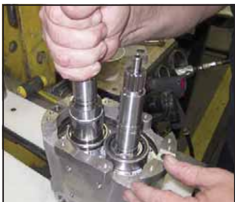
Obrázek 189 - Umístěte hnací hřídel do otvoru
