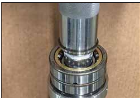
Obrázek 172 - Natlačte oběžnou drážku do ložiska
