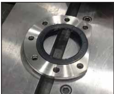
Obrázek 195 - Nainstalované těsnění přídržné desky ložiska
