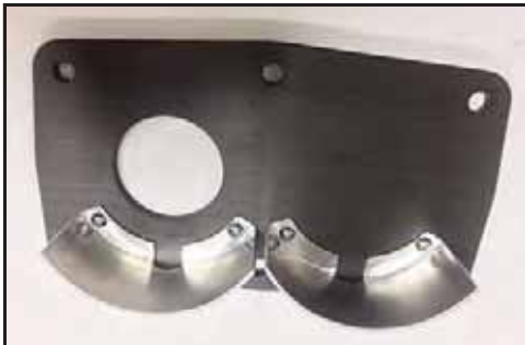
Obrázek 233 - Nainstalované krycí plechy
