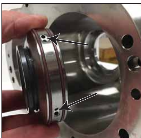
Obrázek 76 - Nainstalujte unašeč ucpávky do tělesa
