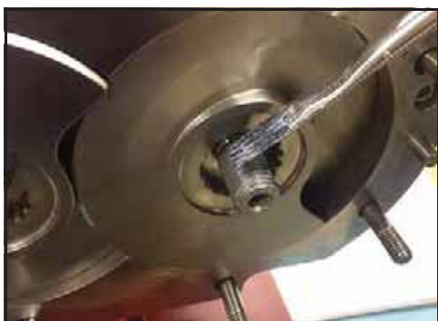
Obrázek 118 - Použijte prostředek proti „srůstání“ závitů
