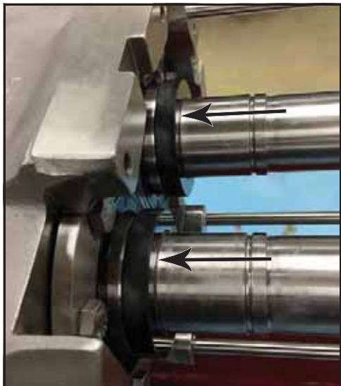
Obrázek 53 - Demontujte sedla ucpávek
