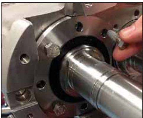
Obrázek 143 - Uvolněte a vyšroubujte šrouby upevňující ložisko
