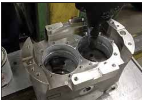
Obrázek 185 - Rozetřete vrstvu, aby byla rovnoměrná
