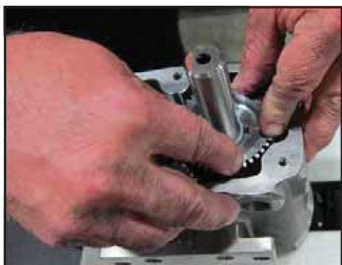
Obrázek 203 - Nainstalujte hnací kolo
