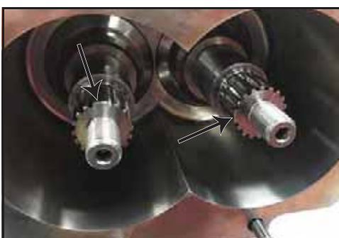
Obrázek 108 - Vyrovnejte drážky na rotoru a hřídeli
