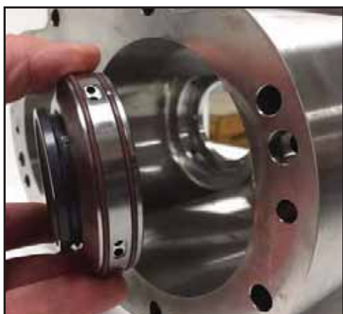
Obrázek 57 - Demontujte unašeč ucpávky z tělesa
