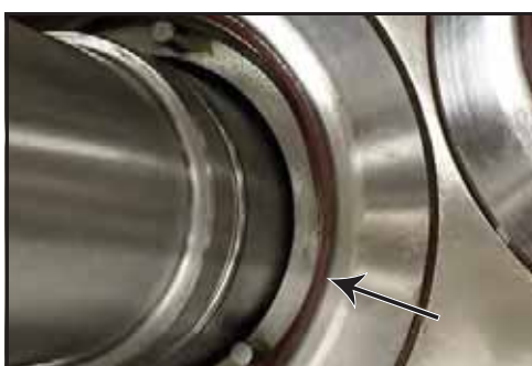
Obrázek 49 - Demontujte O-kroužek mezi unašečem a ucpávkou
