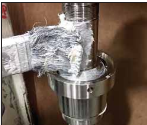
Obrázek 161 - Použijte na hřídel prostředek proti „srůstání“ závitů
