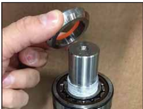
Obrázek 178 - Nasaďte na hřídel pojistnou matici
