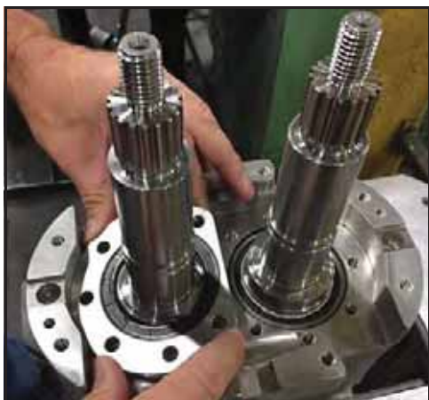
Obrázek 144 - Demontujte přídržnou desku ložiska
