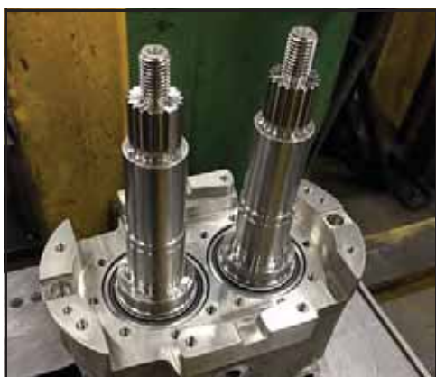
Obrázek 192 - Hřídele umístěné v převodové skříni
