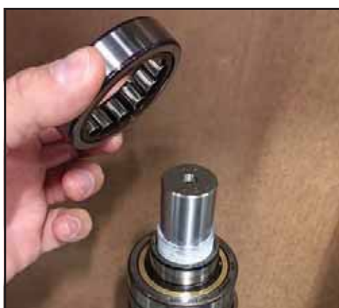
Obrázek 177 - Umístěte ložisko na oběžnou drážku
