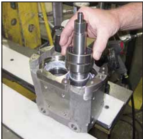
Obrázek 188 - Nasad'te na hřídel vnější oběžnou drážku
