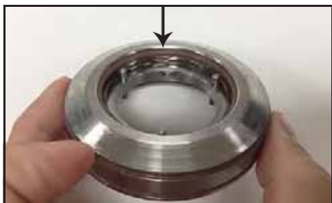
Obrázek 70 - Nainstalovaný O-kroužek mezi unašečem a ucpávkou
