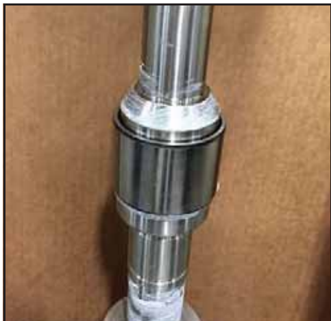
Obrázek 156 - Vnitřní oběžná drážka nainstalovaná na hřídeli
