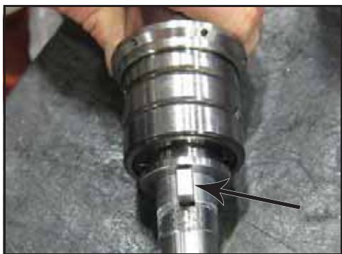
Obrázek 181 - Vložte klín do klínové drážky
