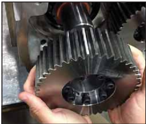
Obrázek 213 - Nainstalujte kola na hřídele čerpadla
