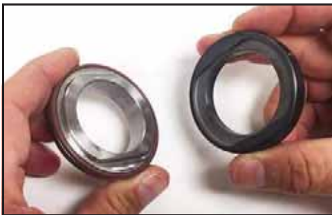
Obrázek 44 - Z víka ucpávky demontujte sedlo ucpávky
