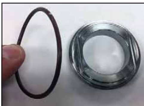
Obrázek 97 - Nainstalujte O-kroužek mezi víkem a sedlem
