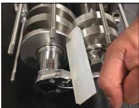
Obrázek 219 - Nainstalujte matice rotorů
