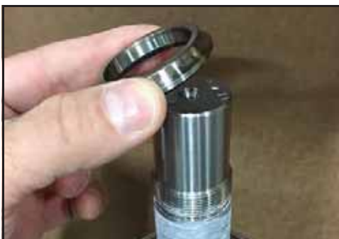
Obrázek 162 - Nasad'te oběžnou drážku na hřídel
