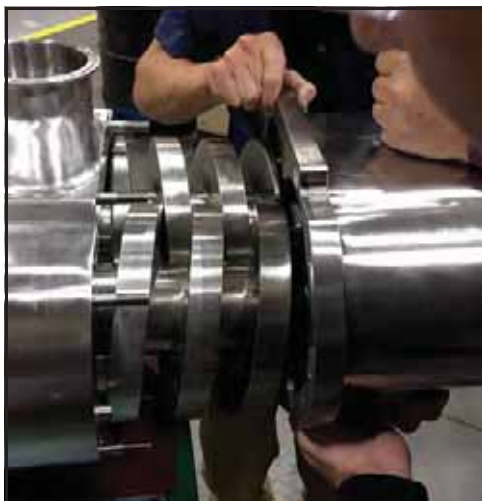
Obrázek 129 - 220-UTS: nasad'te kryt čerpadla
