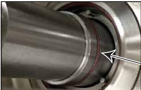
Obrázek 94 - Nainstalujte O-kroužek hřídele
