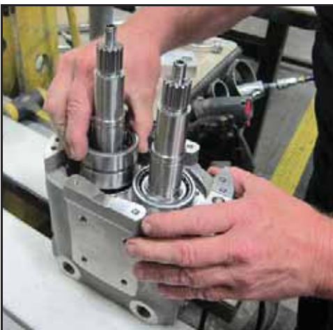
Abbildung 190 - Aufsetzen des Außenrings auf die Welle
