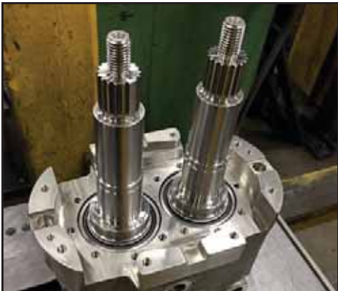
Abbildung 192 - Wellen im Getriebegehäuse montiert
