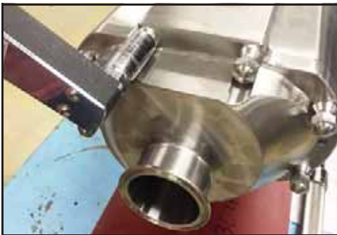
Abbildung 27 - Die Deckelmutter abschrauben
