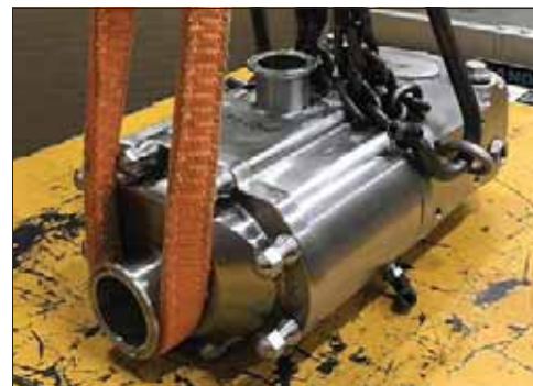
Abbildung 2 - Hebepunkt Detaildarstellung - 015, 030-UTS
