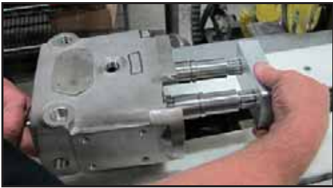
Abbildung 136 - Blockieren der Wellen
