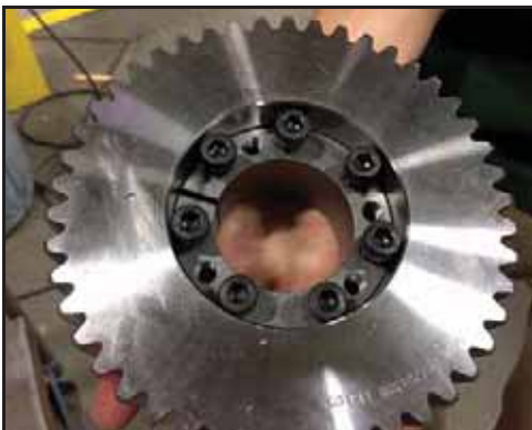
Abbildung 212 - Einsetzen der Sicherungsbaugruppe in das Zahnrad
