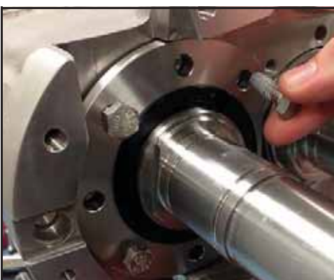
Abbildung 143 - Lösen und Entfernen der Lageraufnahmeschrauben
