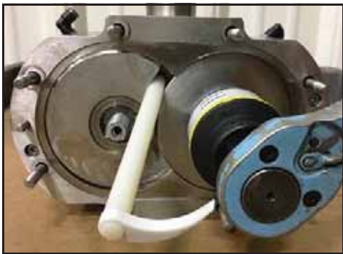
Abbildung 34 - Den Stab einsetzen
