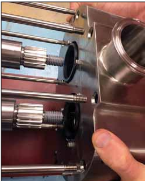
Abbildung 87 - Montage des Pumpengehäuses auf den Wellen
