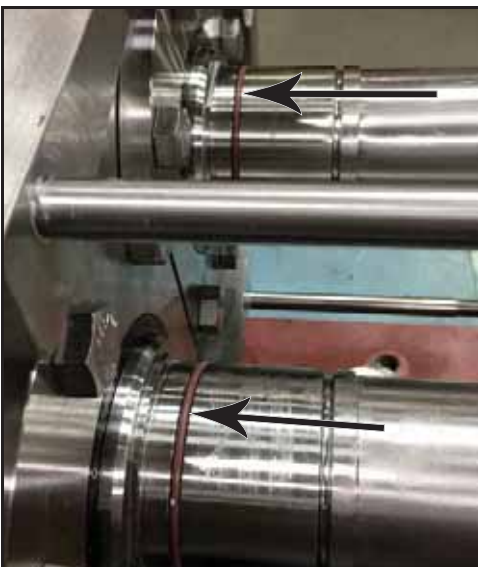
Abbildung 84 - Montage der Wellen-O-Ringe
