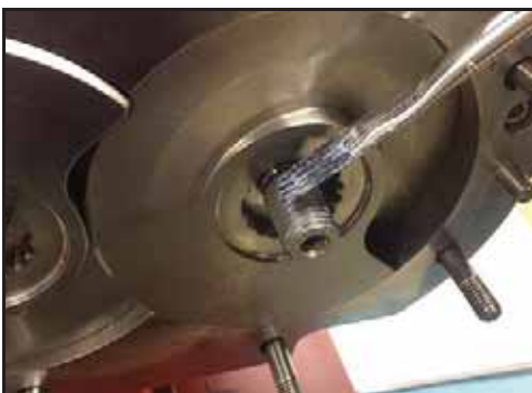
Abbildung 118 - Auftragen von Gleitmittel
