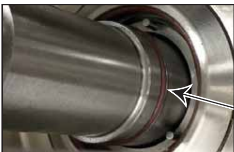
Abbildung 94 - Montage des Wellen-O-Rings
