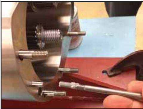
Abbildung 51 - Herausnehmen der Gehäusebefestigungsschrauben
