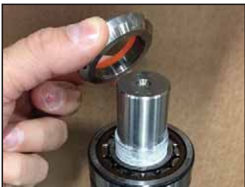
Abbildung 178 - Die Sicherungsmutter auf die Welle aufsetzen
