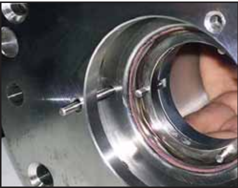
Abbildung 78 - Verwenden Sie zum Fluchten der Bohrungen einen Dorn
