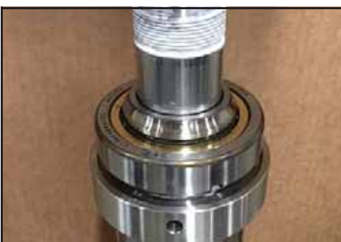
Abbildung 169 - Einpressen des Laufrings in das Lager
