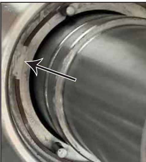
Abbildung 68 - Lage der Dichtungswellenfeder
