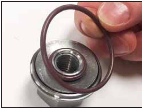
Abbildung 38 - Den O-Ring der Rotormutter herausnehmen
