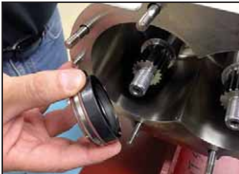
Abbildung 43 - Ausbauen der Dichtungskappenbaugruppe
