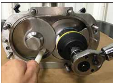
Abbildung 122 - Den Stab drehen
