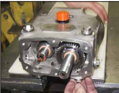
Abbildung 209 - Montage der Stopfen
