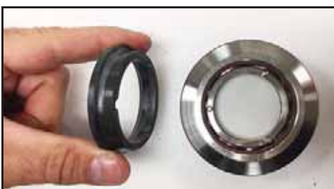
Abbildung 73 - Dichtung schmieren und montieren
