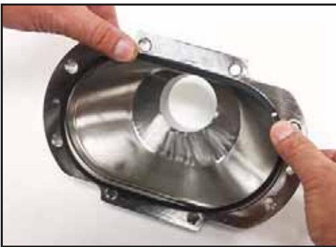
Abbildung 127 - Montage der Deckeldichtung
