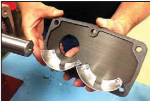
Abbildung 234 - Dichtung auf den Deckel aufsetzen
