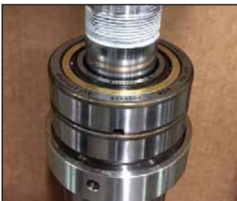
Abbildung 173 - Zweites Lager montiert
