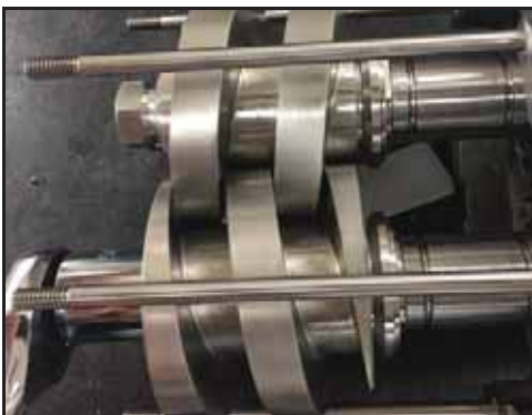
Abbildung 220 - Montage der Rotormuttern
