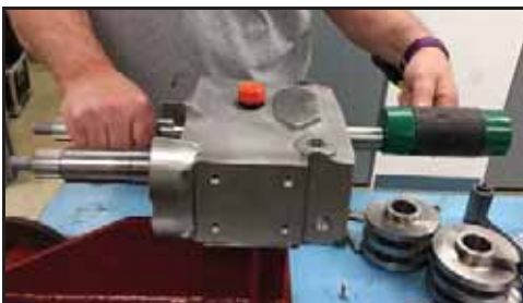
Abbildung 145 - Die Antriebswelle aus dem Getriebegehäuse klopfen
