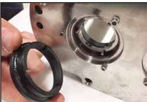
Abbildung 55 - Abnehmen der Dichtung
