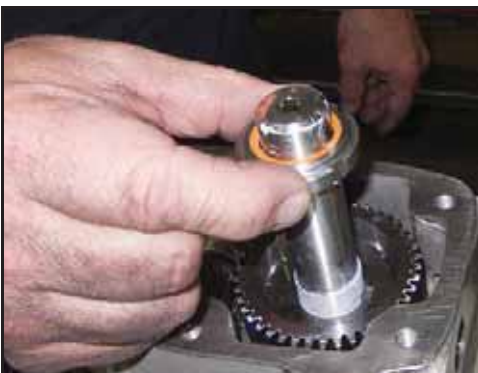
Abbildung 204 - Montage der Sicherungsmutter
