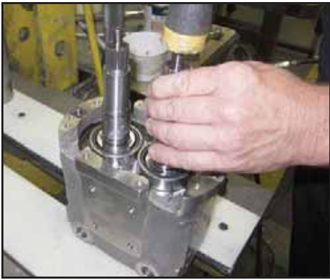
Abbildung 191 - Die Wellen zur Zentrierung in den Bohrungen anklopfen
