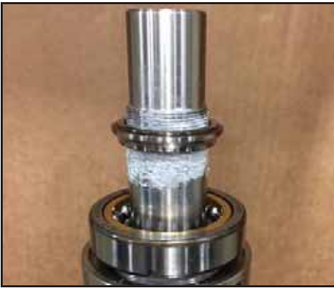
Abbildung 166 - Aufsetzen des Laufrings auf die Welle
