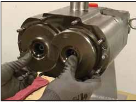
Abbildung 109 - Montage der Rotoren
