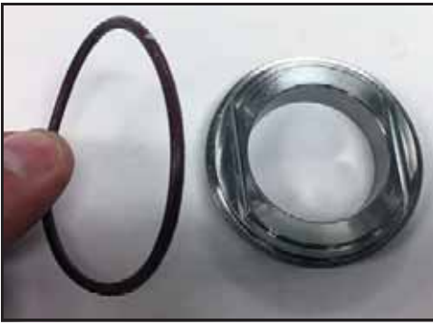
Abbildung 46 - Ausbau des O-Rings zwischen Kappe und Sitz
