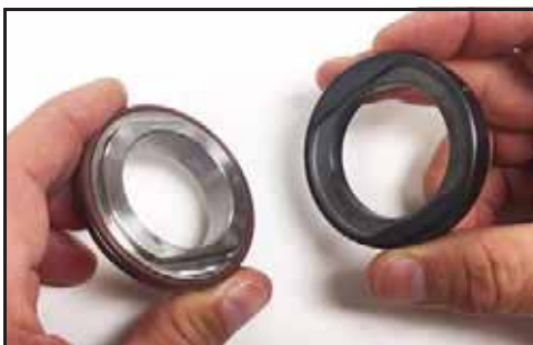
Abbildung 44 - Den Dichtungssitz von der Dichtungskappe abnehmen
