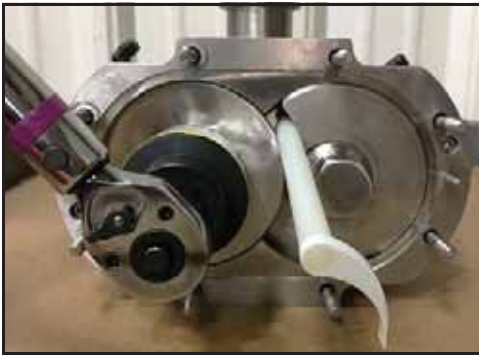
Abbildung 123 - Den Stab einsetzen
