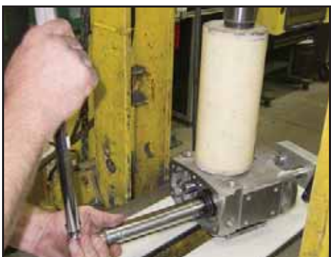
Abbildung 207 - Anziehen der Sicherungsmutter auf Drehmoment
