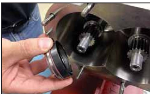
Abbildung 103 - Montage der Dichtungskappenbaugruppe
