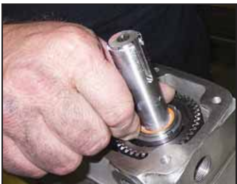
Abbildung 205 - Montage der Sicherungsmutter
