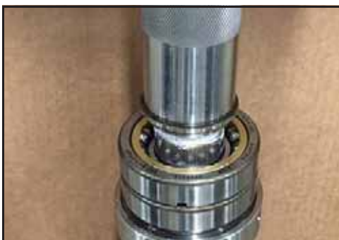
Abbildung 172 - Einpressen des Laufrings in das Lager
