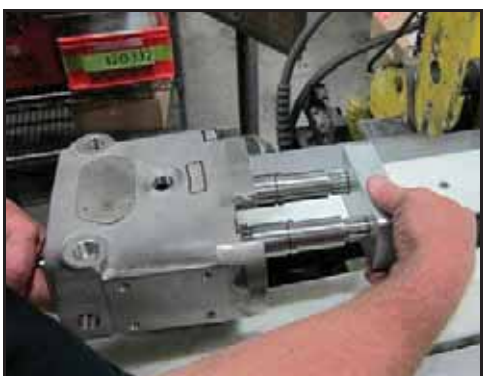
Abbildung 206 - Blockieren der Wellen
