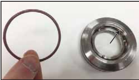
Abbildung 69 - O-Ring zwischen Träger und Dichtung
