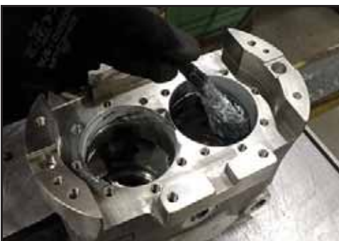
Abbildung 184 - Auftragen von Gleitmittel
