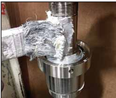
Abbildung 161 - Auftragen von Gleitmittel auf die Welle
