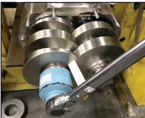
Abbildung 125 - Auf Drehmoment anziehen der linken Rotormutter
