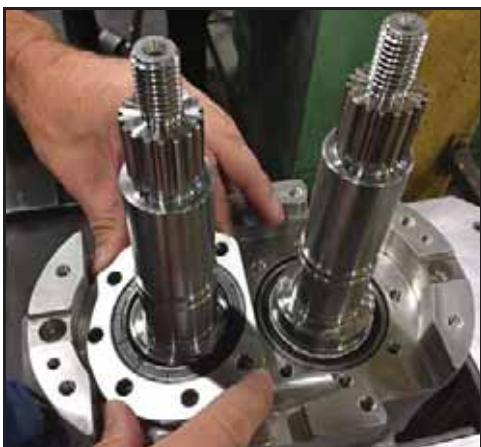
Abbildung 199 - Montage der Lageraufnahme
