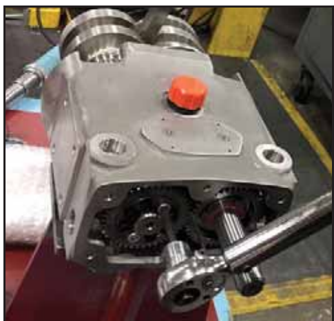
Abbildung 227 - Anziehen der Schrauben der Sicherungsbaugruppe auf Drehmoment
