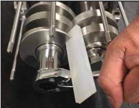
Abbildung 219 - Montage der Rotormuttern
