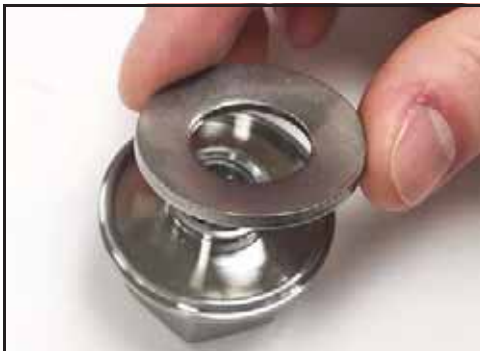
Abbildung 40 - Einsetzen der Belleville-Unterlegscheiben
