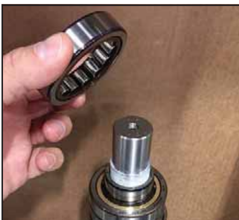
Abbildung 177 - Aufsetzen des Lagers auf den Laufring
