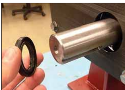
Abbildung 238 - Montage der Öldichtung
