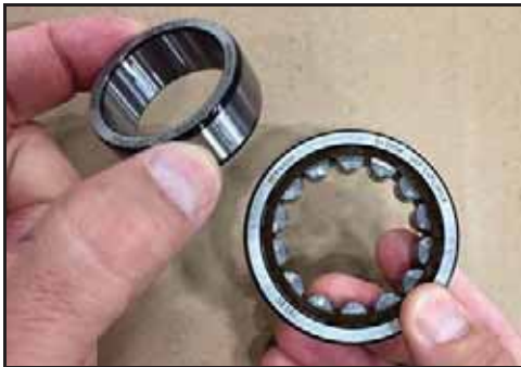
Abbildung 174 - Abnehmen des Laufrings vom Lager
