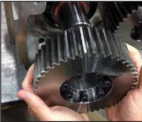
Abbildung 213 - Montage der Zahnräder auf den Pumpenwellen
