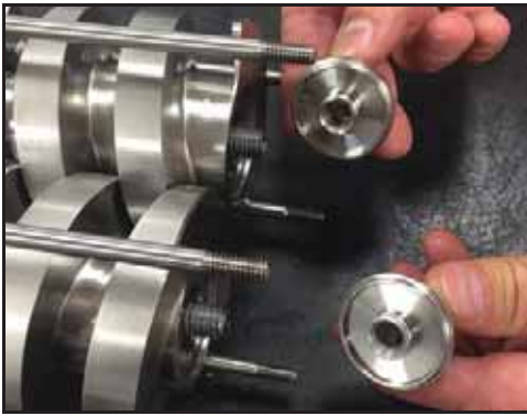
Abbildung 217 - Montage der Rotormuttern
