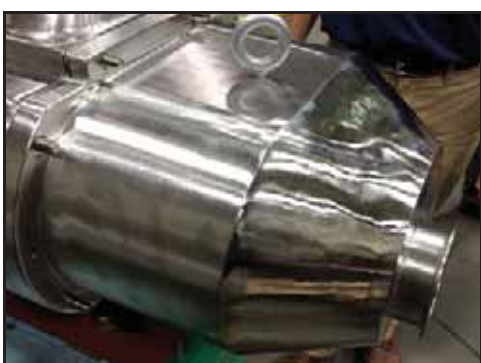
Abbildung 130 - Den Pumpendeckel gegen das Pumpengehäuse drücken
