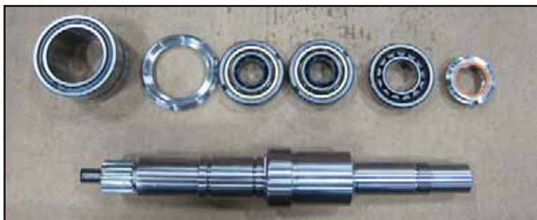
Abbildung 151 - Kurze Welle: Benötigte Elemente der Baugruppe
