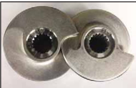
Abbildung 107 - Anordnen der Rotoren: LH-RH (L - R)
