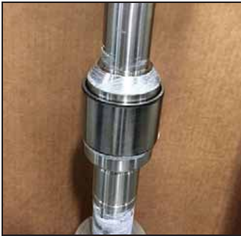
Abbildung 156 - Innenring auf der Welle montiert
