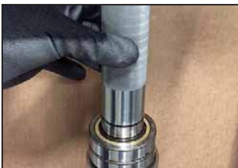
Abbildung 176 - Pressen des Laufrings auf die Welle
