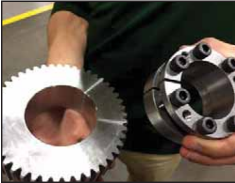
Abbildung 211 - Montage der Sicherungsbaugruppe in das Zahnrad
