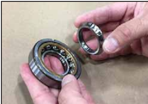
Abbildung 160 - Entfernen des unteren Laufrings
