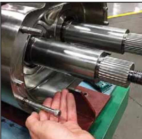
Abbildung 90 - Montieren Sie die Gehäusebefestigungsschrauben
