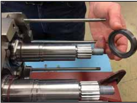
Abbildung 85 - Montage der Dichtungssitze
