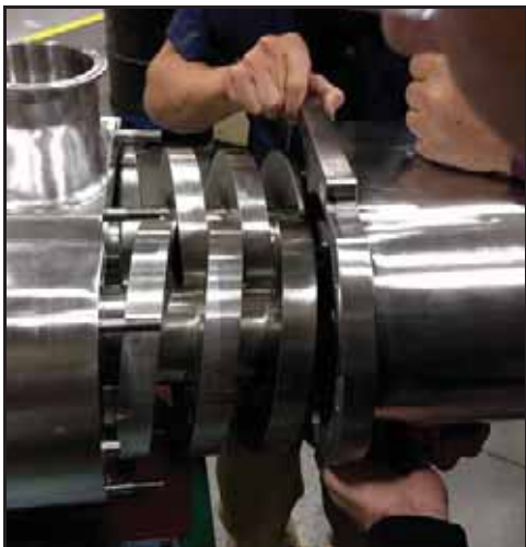
Abbildung 129 - 220-UTS Montage des Pumpendeckels
