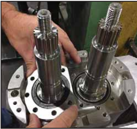
Abbildung 144 - Ausbau der Lageraufnahme
