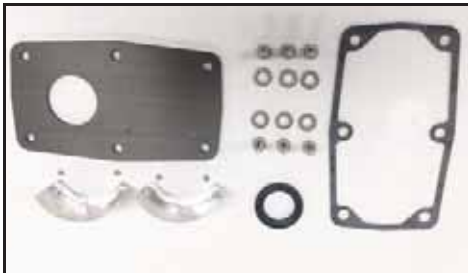
Abbildung 229 - Die Komponenten des Getriebegehäusedeckels
