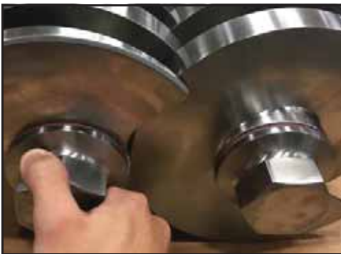
Abbildung 124 - Montage der Rotormuttern
