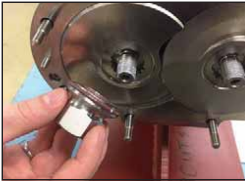
Abbildung 119 - Montage der Rotormuttern
