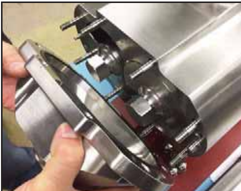
Abbildung 28 - Den Pumpendeckel abnehmen
