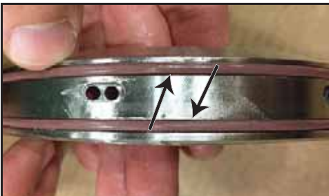
Abbildung 62 - O-Ringe zwischen Träger und Gehäuse
