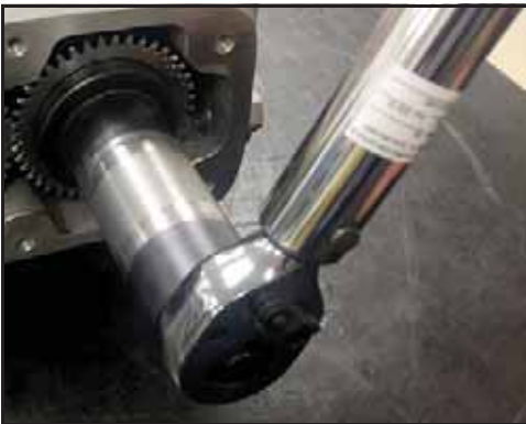
Abbildung 141 - Lösen der Befestigungsmutter
