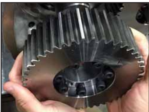
Abbildung 139 - Ausbau des Zahnrads
