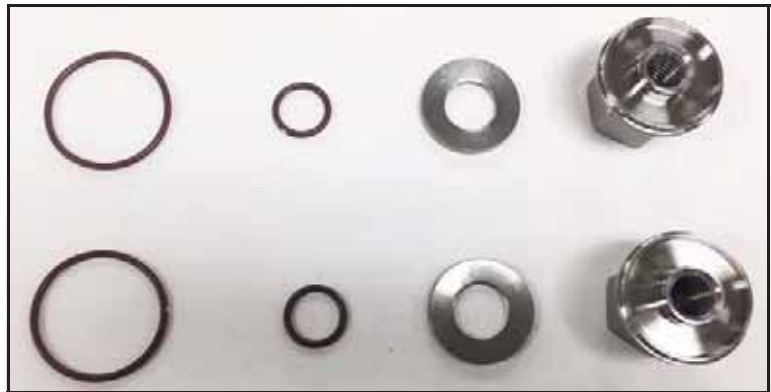
Abbildung 112 - Die Bestandteile der Rotormutter
