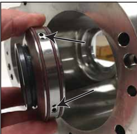
Abbildung 76 - Montage des Dichtungsträgers im Gehäuse
