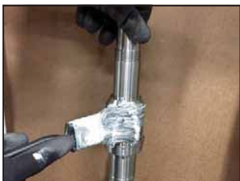
Abbildung 152 - Auftragen von Gleitmittel
