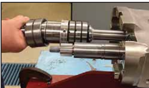
Abbildung 146 - Die Antriebswelle aus dem Getriebegehäuse ziehen
