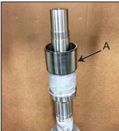
Abbildung 154 - Setzen Sie den Innenring auf die Welle
