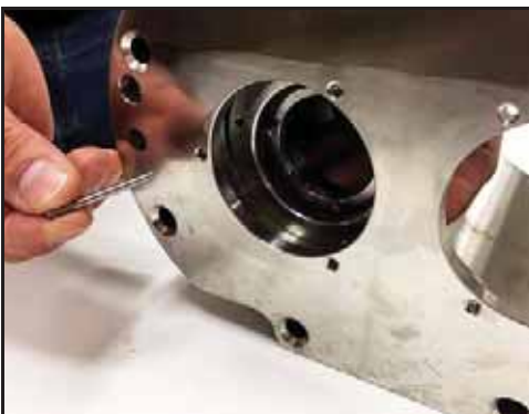
Abbildung 77 - Verwenden Sie zum Fluchten der Bohrungen einen Dorn
