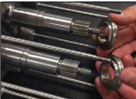
Abbildung 215 - Montage der Dichtungs-kappen
