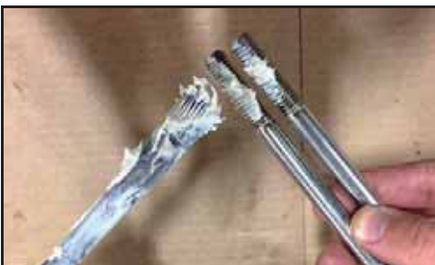
Abbildung 89 - Gleitmittel auf die Gewinde auftragen
