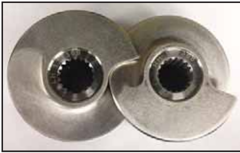
Abbildung 42 - Rotorenanordnung L - R (Markierung LH - RH)
