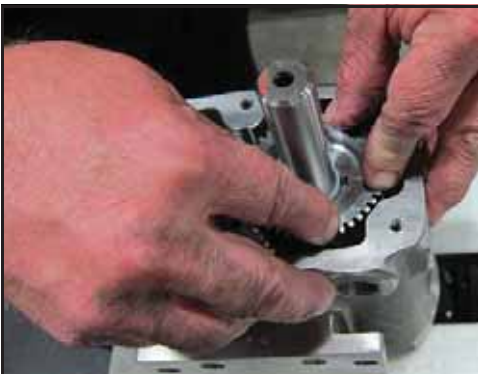
Abbildung 203 - Montage des Antriebszahnrad
