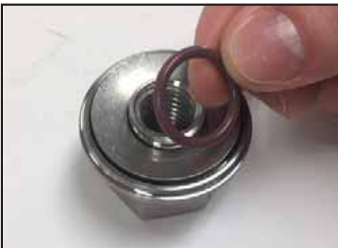
Abbildung 114 - Montage des O-Rings, der die Unterlegscheibe hält
