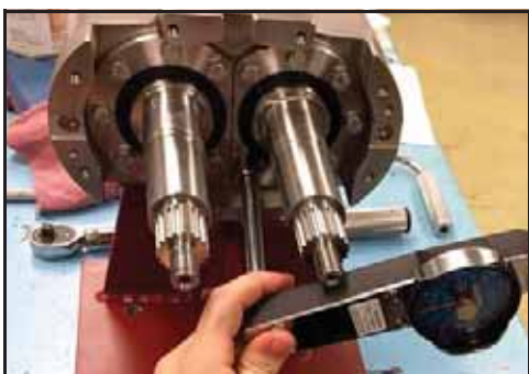
Abbildung 201 - Festziehen der Lageraufnahmeschrauben auf Drehmoment
