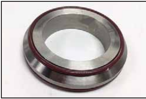
Abbildung 100 - O-Ring zwischen Kappe und Rotor ist montiert
