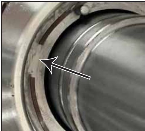
Abbildung 92 - Lage der Dichtungswellenfeder
