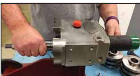
Abbildung 147 - Die kurze Welle aus dem Getriebegehäuse klopfen
