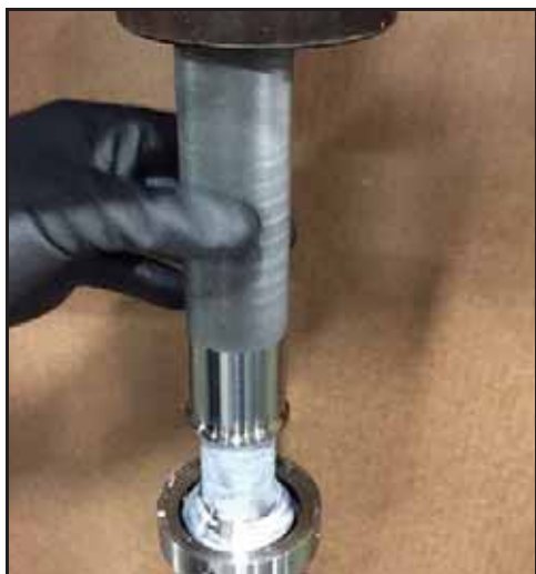
Abbildung 163 - Pressen des Rings auf die Welle
