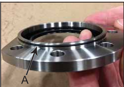
Abbildung 197 - Montierter O-Ring der Lageraufnahme
