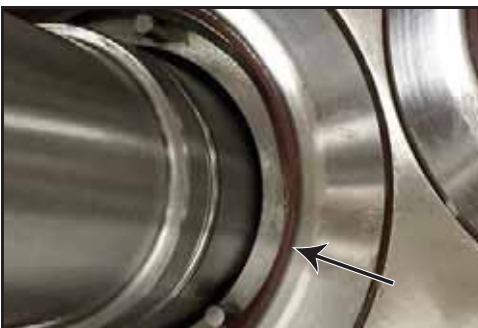
Abbildung 49 - Ausbau des O-Rings zwischen Träger und Dichtung
