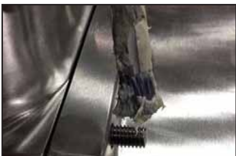
Abbildung 131 - Gleitmittel auf die Gewinde auftragen
