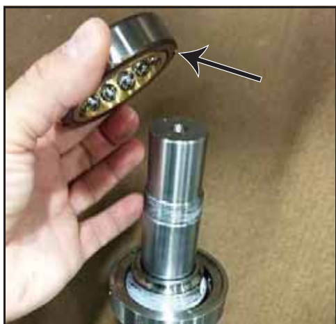
Abbildung 165 - Aufsetzen des Lagers auf den Laufring
