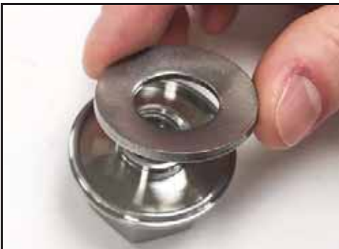
Abbildung 113 - Einsetzen der Belleville-Unterlegscheiben
