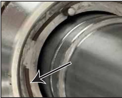
Abbildung 50 - Abnehmen der Dichtungswellenfeder
