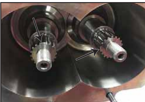
Abbildung 108 - Fluchten von Rotor und Wellenverzahnung
