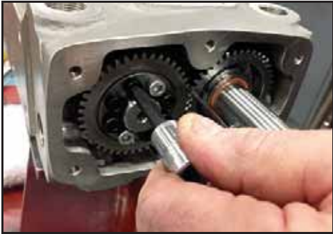
Abbildung 137 - Lösen der Schrauben in der Befestigungsbaugruppe
