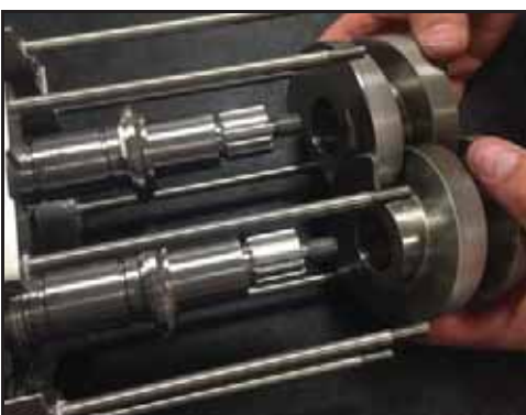
Abbildung 216 - Montage der Wellen
