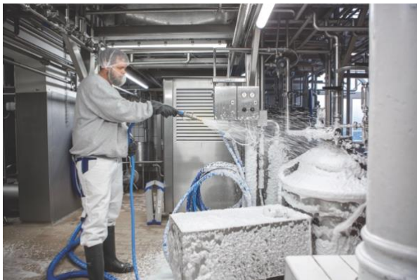
Manuelle Niederdruck-Reinigung in einem milchverarbeitenden Betrieb (Bild: System Cleaners)
