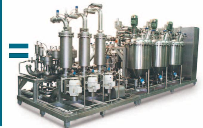
Systèmes de mélange de colorants conçus pour le dosage et le mélange de colorants et d'arôme sur une chaîne de production de dentifrice. Le système comprend un dispositif de préparation des colorants à partir de pigments en poudre. Il est extrêmement fiable, et précis à <math>0,2\%</math>. Il prend en charge les fonctions CIP et SIP, ainsi que le pilotage et la communication sur via le système SCADA du site.
