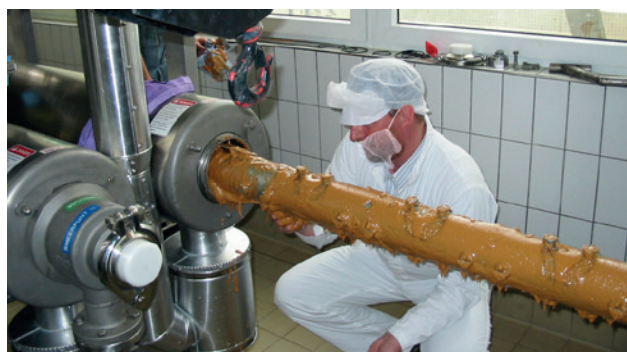
Onderhoud aan de Votator II op een installatie voor de kristallisatie van pindakaas.
