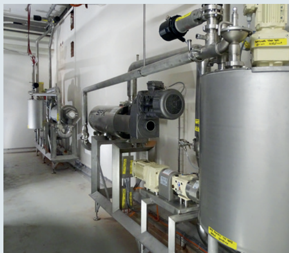
De chocolade wordt vanuit de ontvangttank door middel van Waukesha Votators teruggekoeld voor verdere verwerking in het productieproces.
