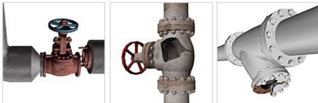
EKSEMPEL PÅ RØR SKADET AV TRYKKSTØT
