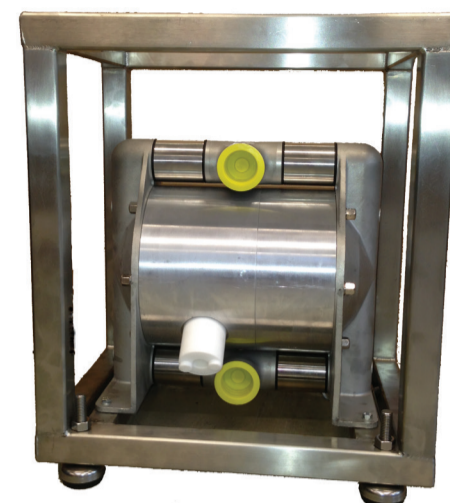
AH32STT høytrykkspumpe bygget inn etter kundespesifikasjon
