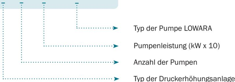
1. MHP – mikroprozessorgesteuerte Druckerhöhungsanlage mit Kaskadenregelung über einen Drucksensor
