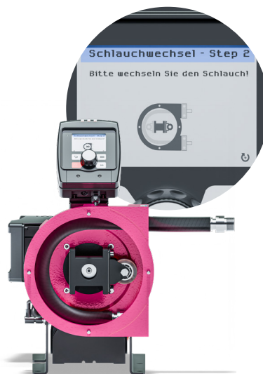
Demontage von Schellen & Schlauch. Der Rotor fährt automatisch in die Positionen.
