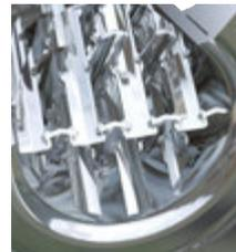
Die entlang der Rinne jeder Lamelle geleiteten Ströme von Additiven mit niedriger Viskosität werden abrupt von schnell fließenden Querströmen gekreuzt, die in entgegengesetzter Richtung fließen.
