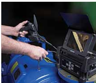
KONTROLL AV VAKUUMPUMPAR
