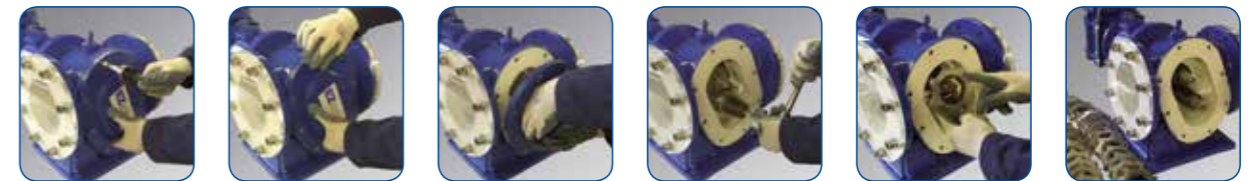
Inspektera och demontera knivarna genom locket på framsidan.
